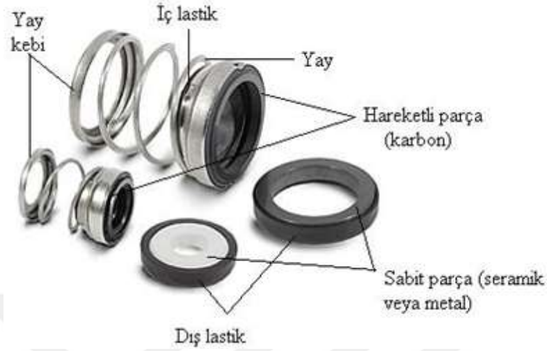
Şekil 3.6: Mekanik Salmastra İç Yapısı
