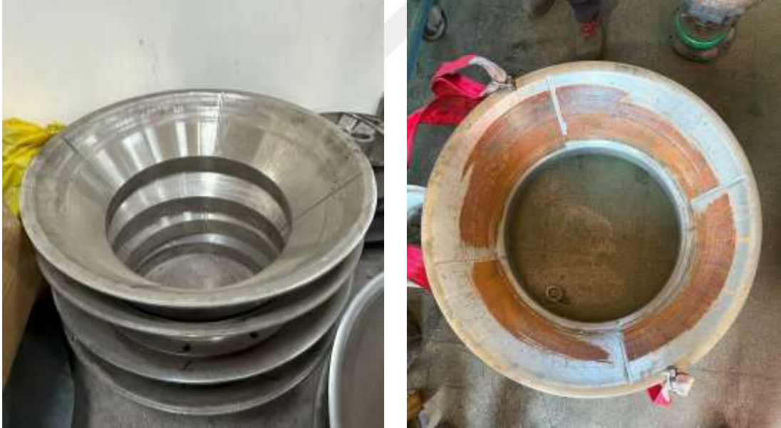
Şekil 3.9: Yeni ve Arıza Sebebiyle Demontajı Yapılan Aşınma Halkaları
