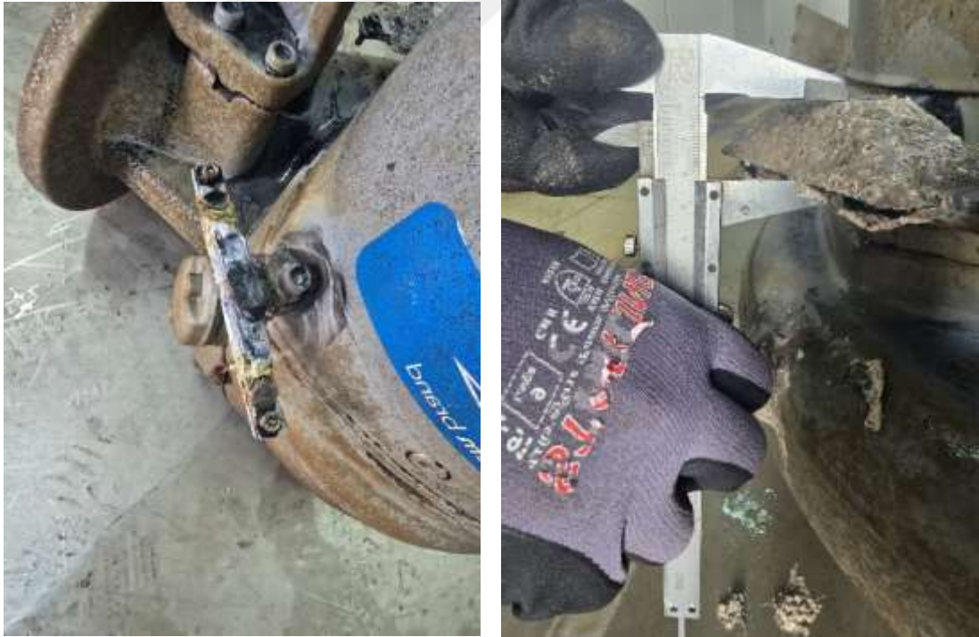
Şekil 3.13: Eriyen Galvanik Anot Ölçüm ve Kontrolleri
