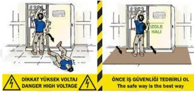
Resim 2. Üzerinde durulan yerin yalıtılmasında kullanılan malzemeler
