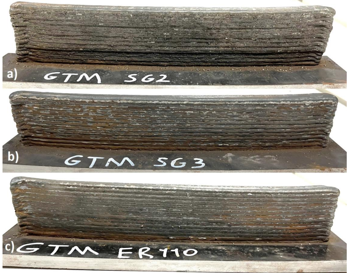
Şekil 5.7: Farklı kaynak telleri kullanılarak üretilen düşük alaşımlı çelik parçaların yan yüzeyden dikiş görüntüleri; a) SG2, b) SG3 ve c) ER110
