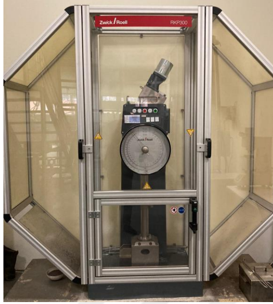
Şekil 4.12: Charby çentik darbe deney cihazı
