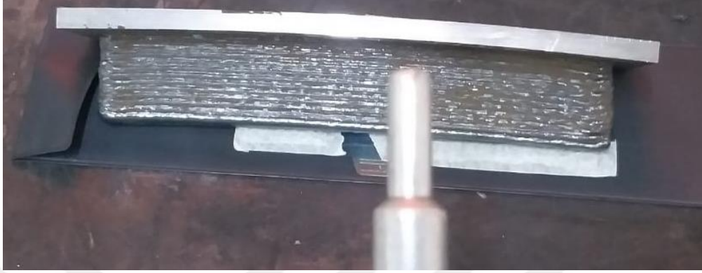
Şekil 4.11: Üretilen parça için gama çekim pozisyon parametrelerinin ayarlanması
