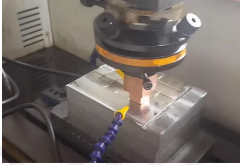
Şekil 54 Dalma Erozyonla yapılan elde edilen soğutma parçaları aşamaları-3
