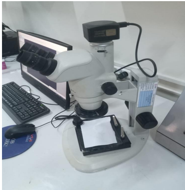
Şekil 11.10: Nikon SMZ745T Makro Cihazı
