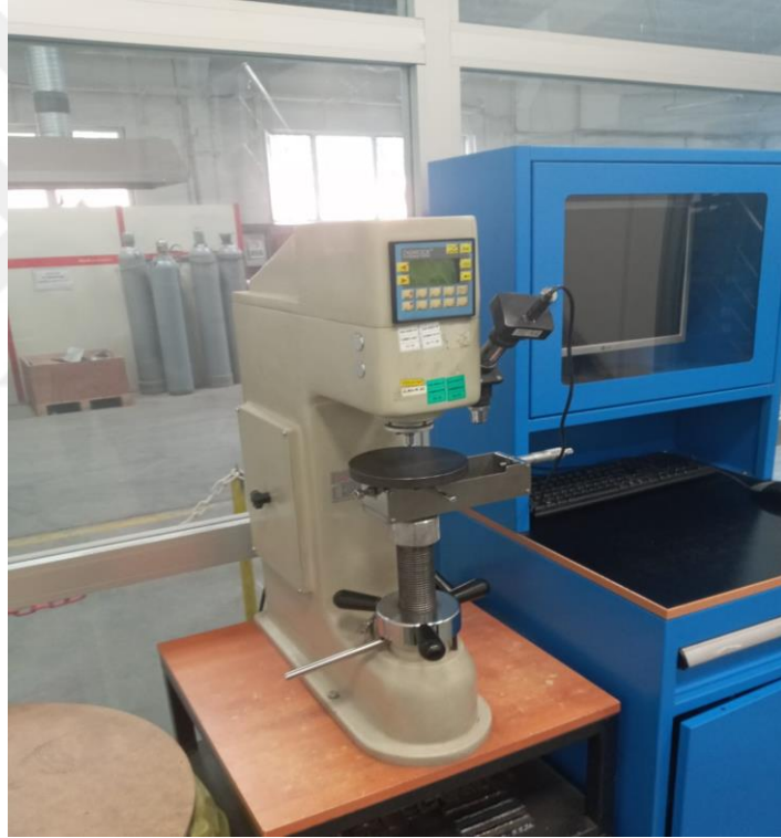
Şekil 11.6: DIGIROCK Makro Sertlik Ölçüm Cihazı
