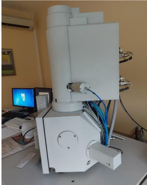
Şekil 11.13: Taramalı Elektron Mikroskobu (SEM) Philips XL 30 FEG
