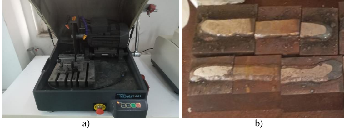
Şekil 11.3: a) Metacut 251 Kesme Makinesi b) Kesildikten Sonra Malzemelerin Son Hali
