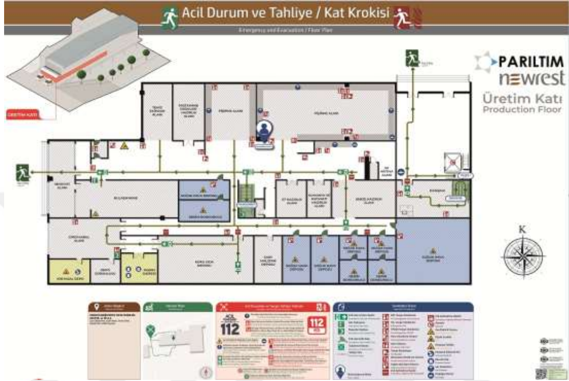
Şekil 2.12: Acil Durum ve Tahliye Krokisi Örneği
