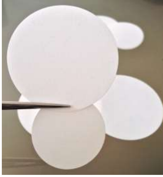
Şekil 5.6: 0,45 µm 47 mm'lik steril membran filtre
