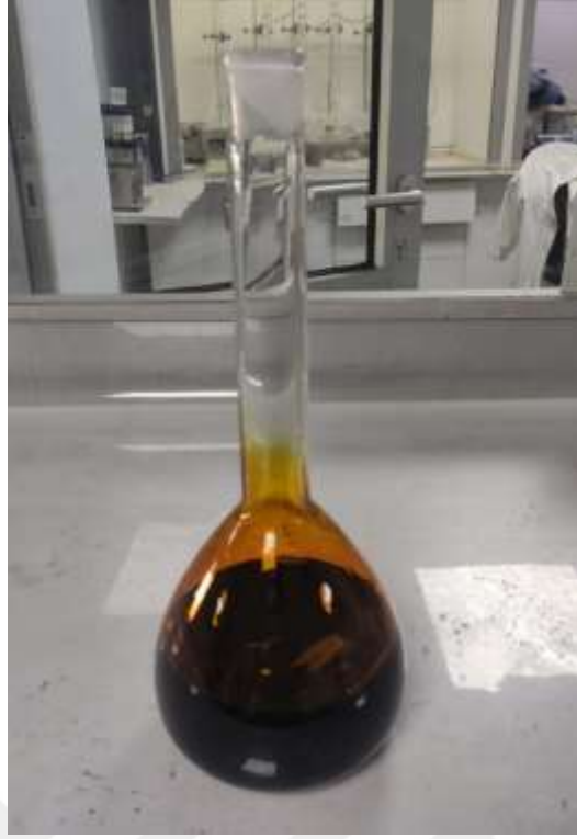
Şekil 6.10: İyottan İyodür Solüsyonu Hazırlanması Basamakları. Distile Su İçerisinde Katı Madde Çözdürülmüş %2'lik Potasyum İyodür Çözeltisi
