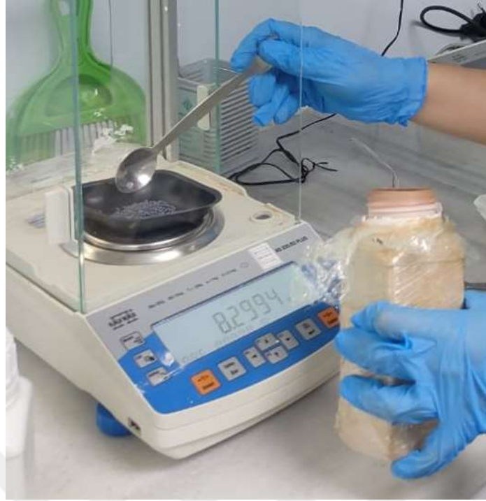
Şekil 6.8: Katı Haldeki Stok İyotun Hassas Terazide Tartımı
