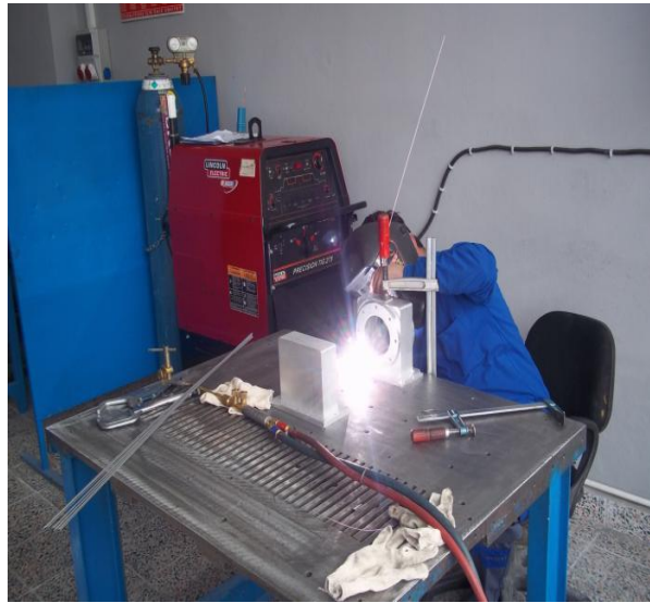
Resim 2.8. Gazaltı TIG kaynağı ( http://ozteknikkaynak.biz/galeri.html , Erişim tarihi: 14 Eylül 2016)
