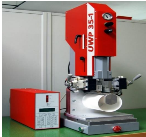
Resim 2.21. Ultrasonik kaynak ( http://hornimalat.com/urunler_1551.htm , Erişim tarihi: 16 Eylül 2016)
