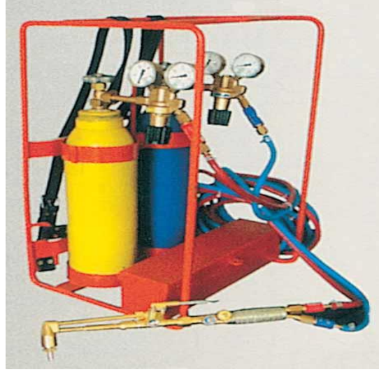
Resim 2.15. Oksi-asetilen kaynağı ( http://www.metaluzmani.com/oksi-gaz-tupleri-depolama-ve-calisma-kurallari/ ,Erişim tarihi: 15 Eylül 2016)
