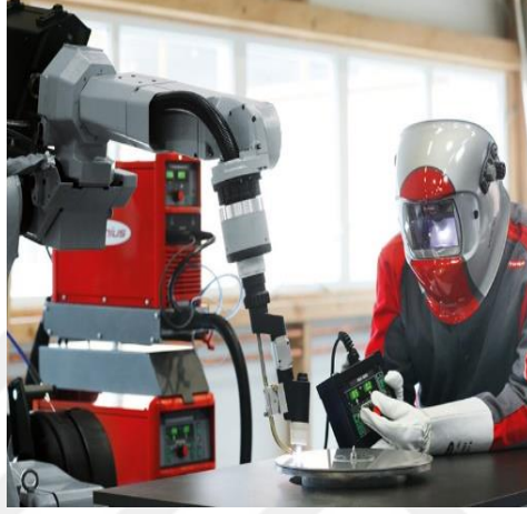
Resim 2.20. Plazma kaynađı ( http://www.alganmetal.com.tr/fronius-soft-plazma-kaynak-makinesi.html , Erişim tarihi: 16 Eylül 2016)
