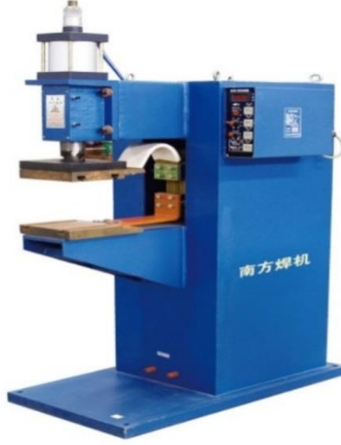
Resim 2.14. Projeksiyon direnç kaynağı ( http://ru.made-in-china.com/co_nanfanghanjie08/product_DT-Pneumatic-Projection-Welding-Machine_hnsuoseug.html ,Erişim tarihi: 14 Eylül 2016)
