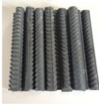
Şekil 6.3: Betonun İçerisine Konulan İnşaat Çelik Çubukları
