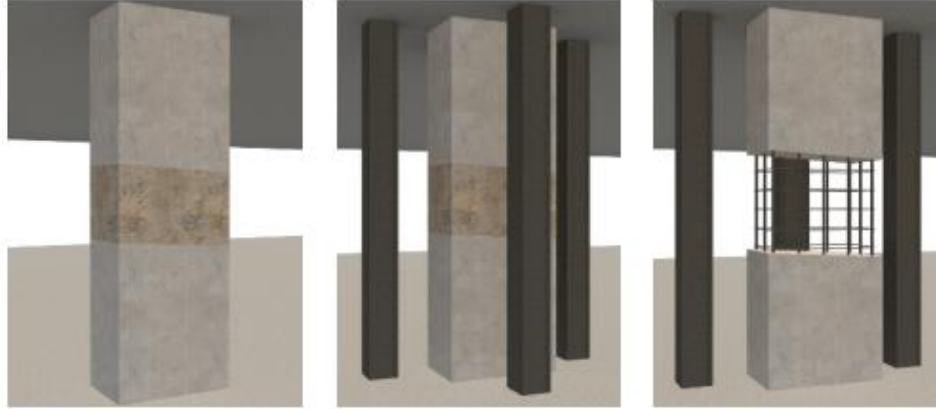
Şekil 6.13: Sırasıyla, Hasarlı Kolon, Askıya Alma İşlemi ve Hasarlı Bölgenin Çıkartılması
