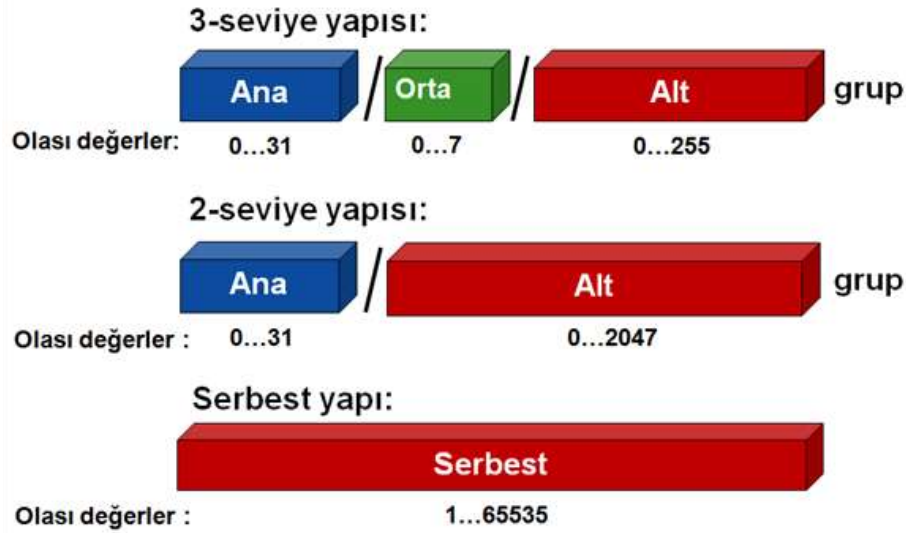
Şekil 2.8: KNX Grup Adreslerinin 3 Seviyeli Hiyerarşik Yapısı
