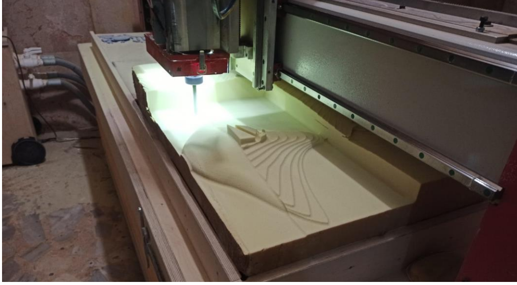
Şekil 3.3: Strafor üzerine 3D çizimin CNC makinası ile işlenmesi
