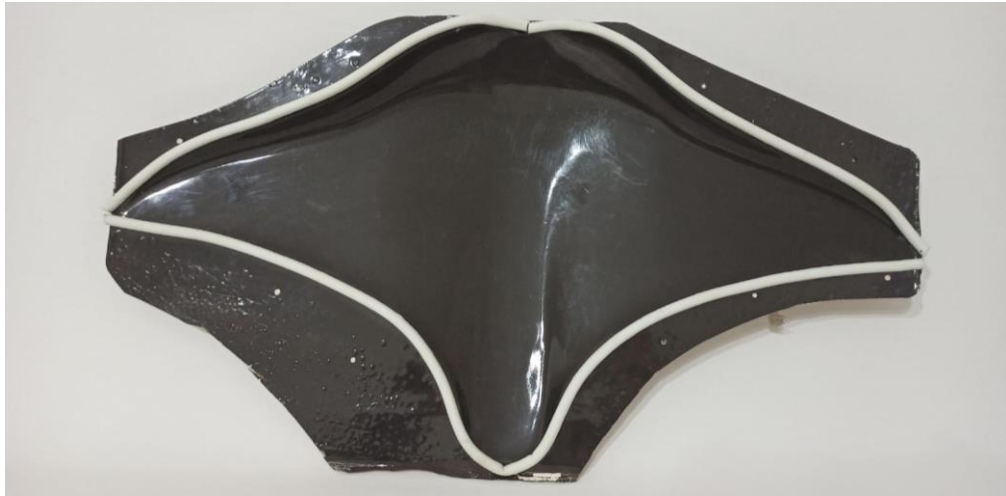
Şekil 3.5: Strafor üzerinden çıkartılan kalıp
