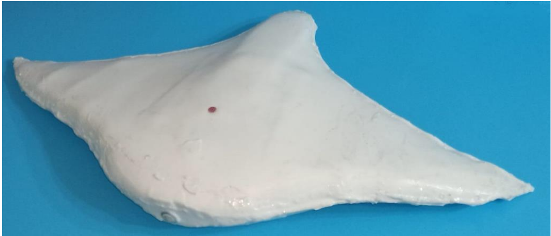
Şekil 4.12: Biyo-ilham robotun silikon kaplandıktan sonraki son hali
