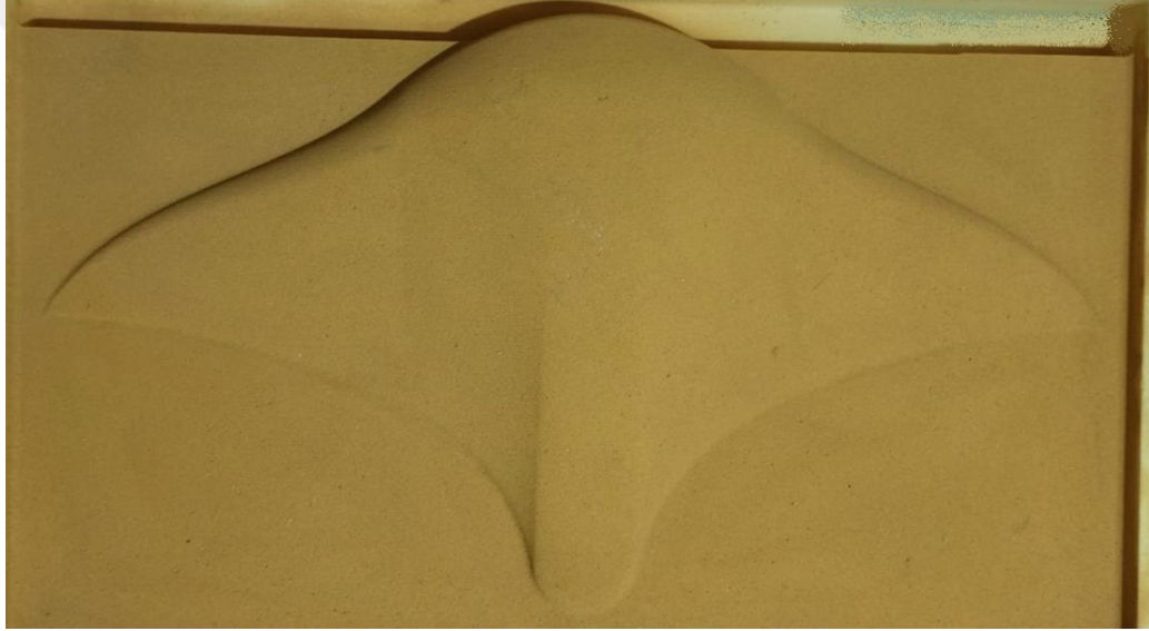
Şekil 3.4: Tasarlanan vatoz balığının CNC makinası ile strafora işlenmiş modeli
