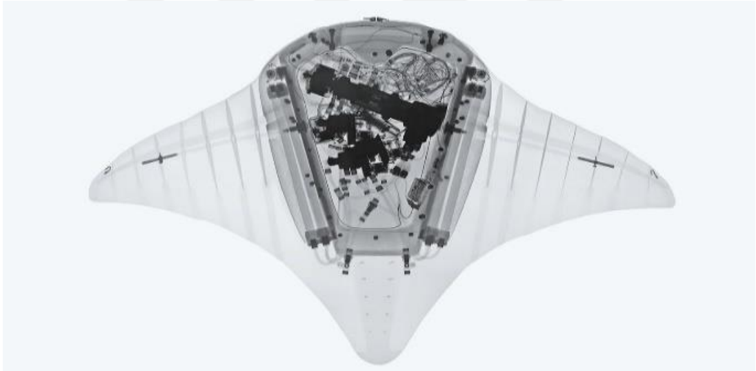
Şekil 2.12: Aquaray’ ın X-Ray ile çekilmiş bir fotoğrafı
