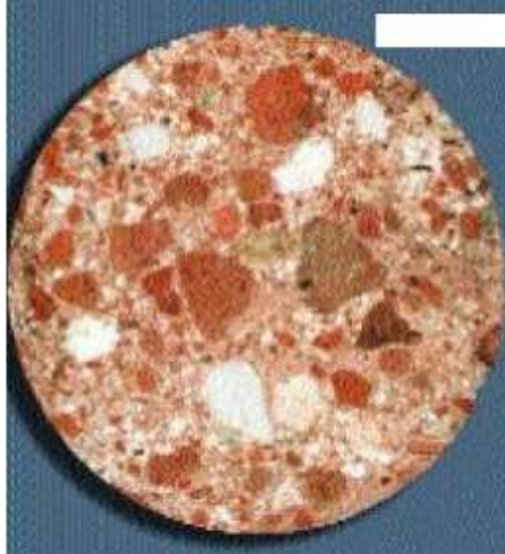
Şekil 7.16: Tuğla Kırığı ve Doğal Agregalar Katılarak Yapılan Horasan Harcı Örneği
