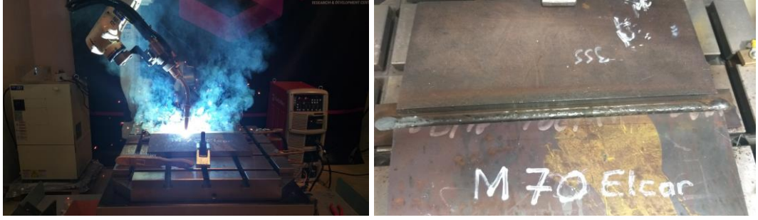
Şekil 8. 11: Metal Özlü Telin Kaynağı Esnasında Bir Görünümü
