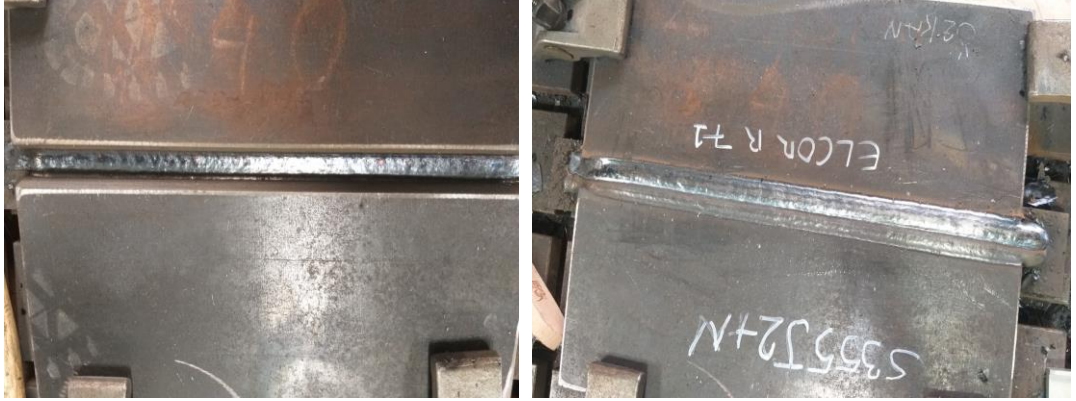
Şekil 8. 9: Pasolar Arası ve Son Kaynak Dikişinin Görünümü
