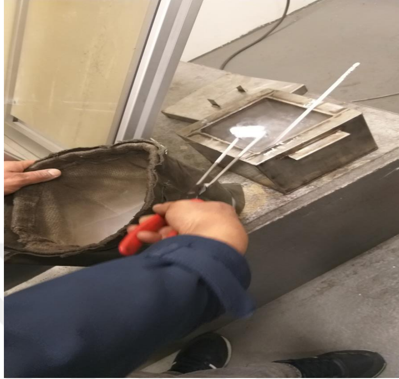
Şekil 9. 13: Test Numunelerini -30°C, -40°C ve -50°C'ye Soğutulması
