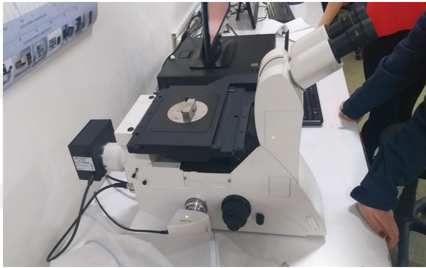
Şekil 9. 22: Işık Metal Mikroskobunda Mikro Yapı Görüntülerin Alınması
