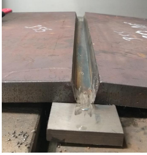
Şekil 8. 2: Kaynak Test Parçasının V-Kaynak Ağız Görünümü
