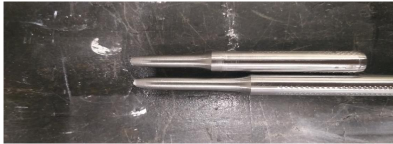
Şekil 9. 8: Rutil Özlü Telin Çekme Testi Sonucunda Test Numunesinin Görüntüsü
