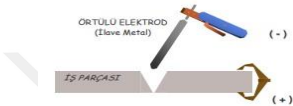
Şekil 2. 6: Örtülü Elektrot Arkı İle Yapılan Kaynak Uygulaması (Erkan, K. 2014)
