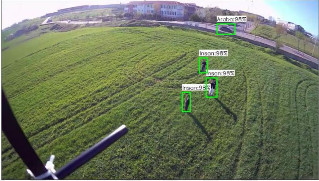
Şekil 4.1: SSD MobileNetV2 Modeli İle Aynı Anda Dört Nesnenin Tespit Edilmesi ve Sınıflandırılması
