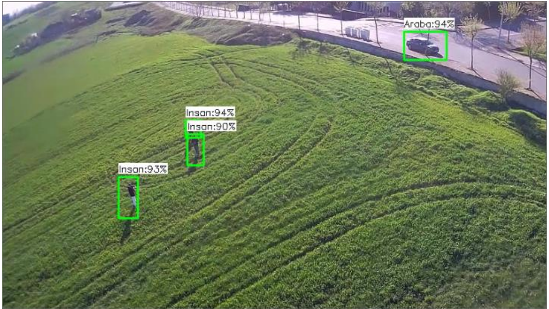
Şekil 4.8: SSD MobileNetV2 Modeli İle Eğimli Kamera Açısı İle Nesne Tespiti
