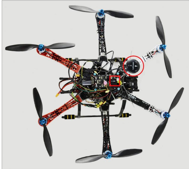
Şekil 2.5: Hexacopter Uçuş Kontrol Kartı ve GPS Modülü Yönü
