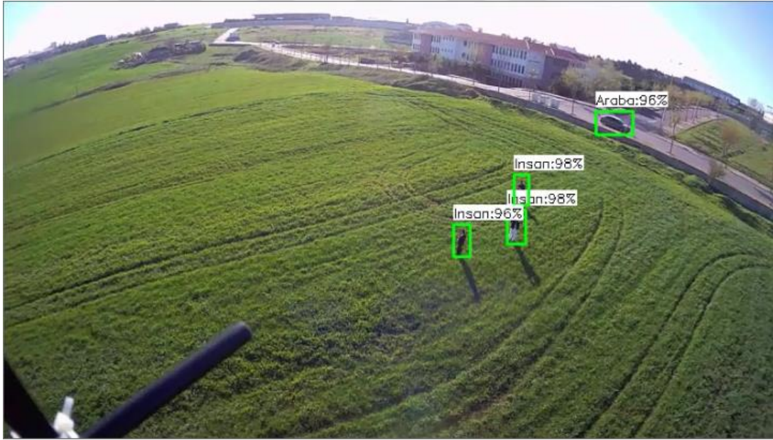
Şekil 4.2: SSD MobileNetV2 Modeli İle Aynı Karede İki Farklı Sınıfa Ait Nesnelerin Tespit Edilmesi
