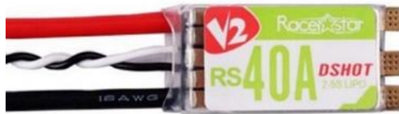
Şekil 2.11: Racerstar RS40A V2 40A BLHELI_S BB2 OPTO 2-5S ESC
