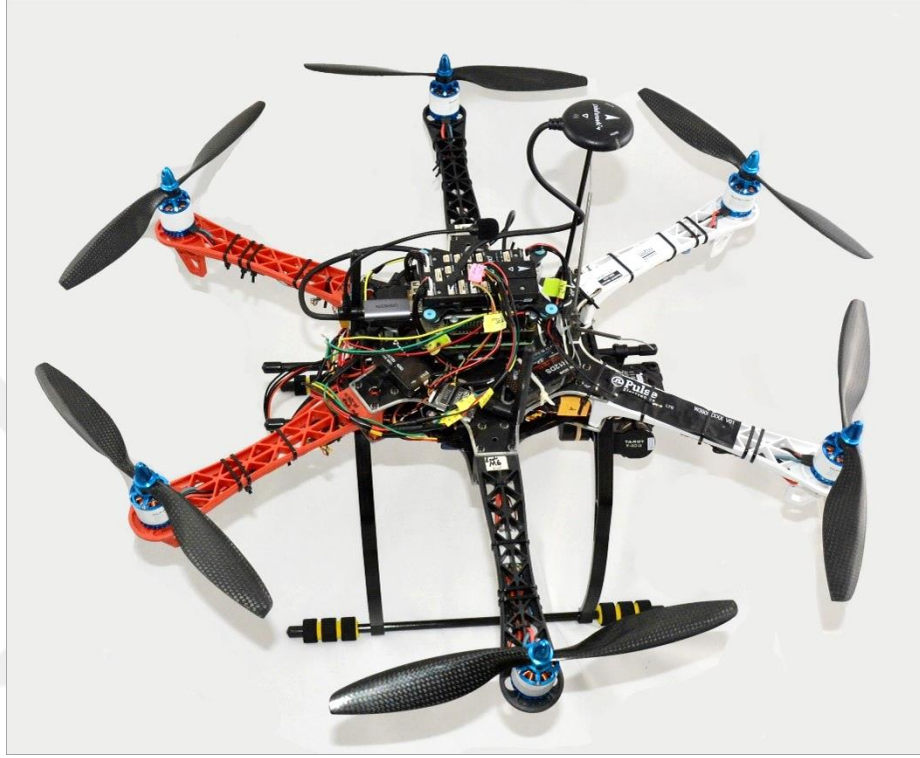
Şekil 3.50: Hexacopter ve Altı Adet Pervaneli Motoru
