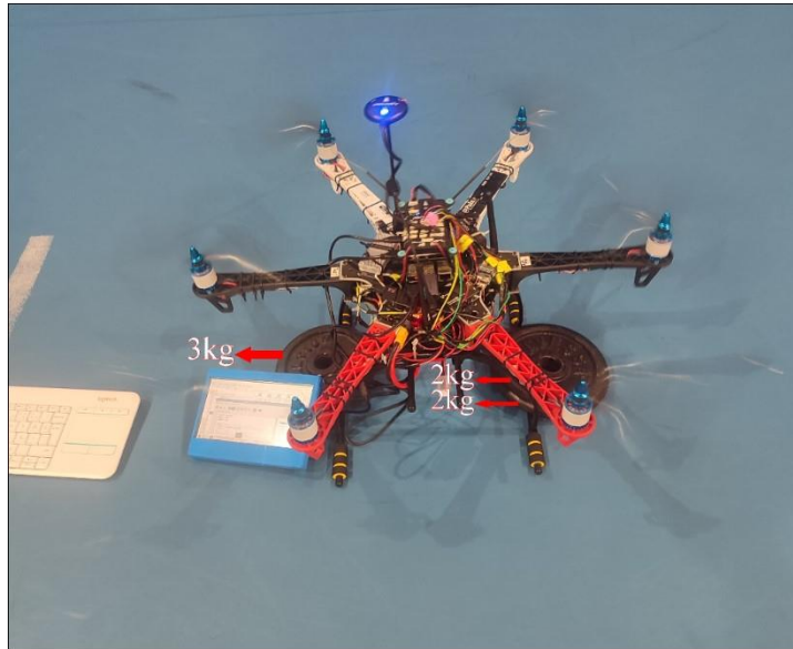
Şekil 4.10: Hexacopter'in Kalkışını Engellemek İçin İniş Takımı Ayaklarına Ağırlık Konulması
