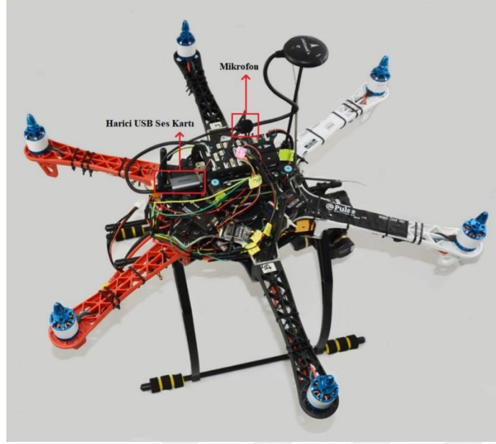
Şekil 3.87: Harici USB Ses Kartı aracılığıyla Raspberry Pi'ye Mikrofon Entegrasyonu
