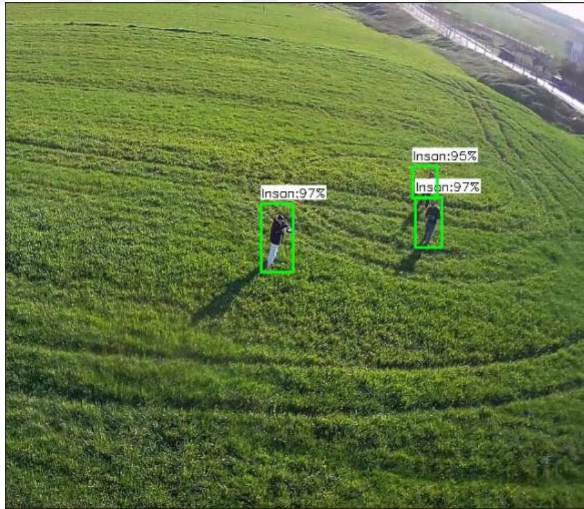
Şekil 3.8: Algılanan Nesnenin Sınırlayıcı Dörtgen Kutu İle Tespit Edilmesi ve Sınıfı
