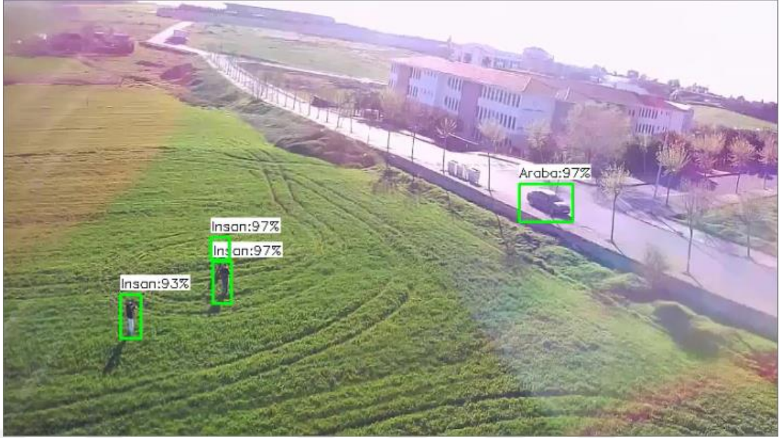
Şekil 4.5: SSD MobileNetV2 Modeli İle Yoğun Güneş Işınları Altında Nesne Tespiti
