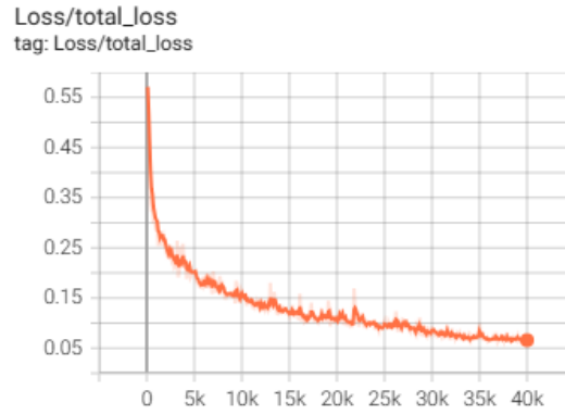
Şekil 3.22: SSD MobilNetV2 Modelinin Eğitim Sırasında Adım Sayısına Göre Toplam Kayıp Değerleri Grafiği
