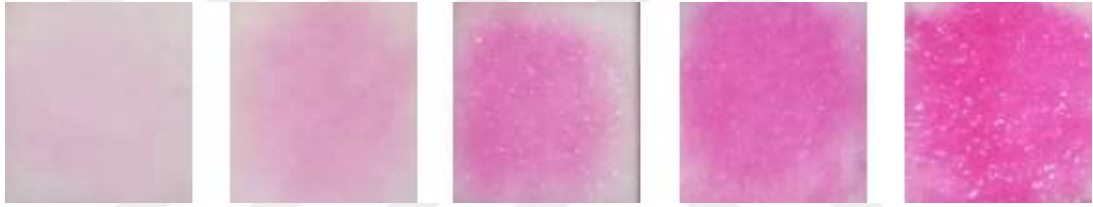
Şekil 4.1: Sırasıyla 4.5, 6.25, 12.5, 25, 50 Uİ/MI Kortizon İçeren Stokların Uygun Oranlarda Renk Reaktifine İle Reaksiyonu Sonrasında Ortaya Çıkan Renk Skalası
