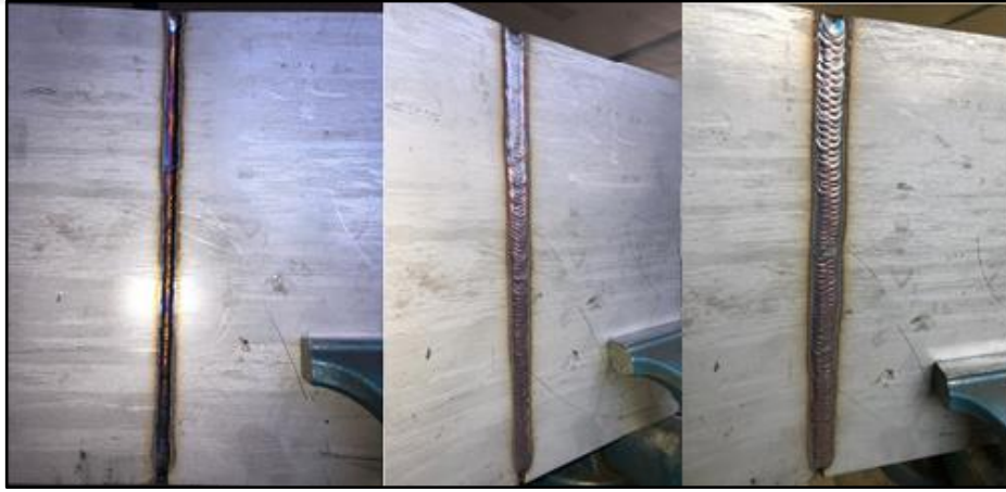
Şekil 5.4 : Kaynak İşlemi Esnasında Sırasıyla 1-2-3. Paso
