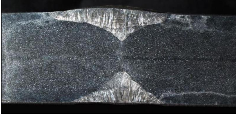
Şekil 5.20 : 175 A akım ile kaynaklanmış plakanın makro yapısı
