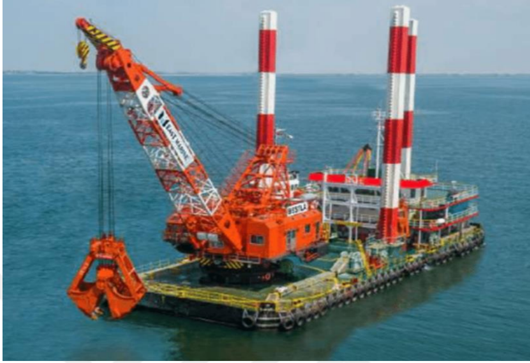
Şekil 3.4: Kapma- Kurtarma Mekanizmasının Yardımcı Araçtaki Yerleşimi
