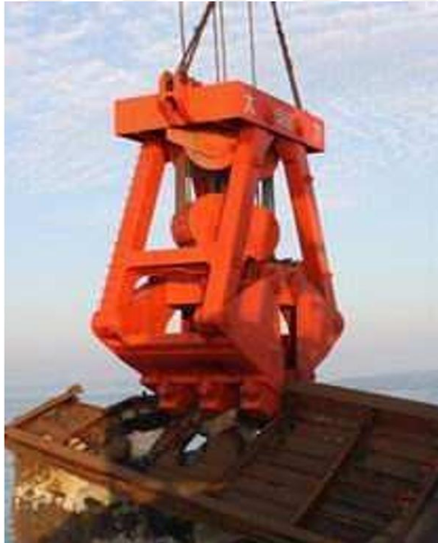
Şekil 2.7: Kapma-Kurtarma Mekanizmasının Batık Gemiye Kurtarma Fotoğrafi
