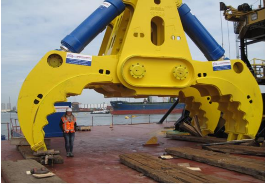
Şekil 3.2: Kapma- Kurtarma Mekanizması Örnek- Açıklık 7 metre
