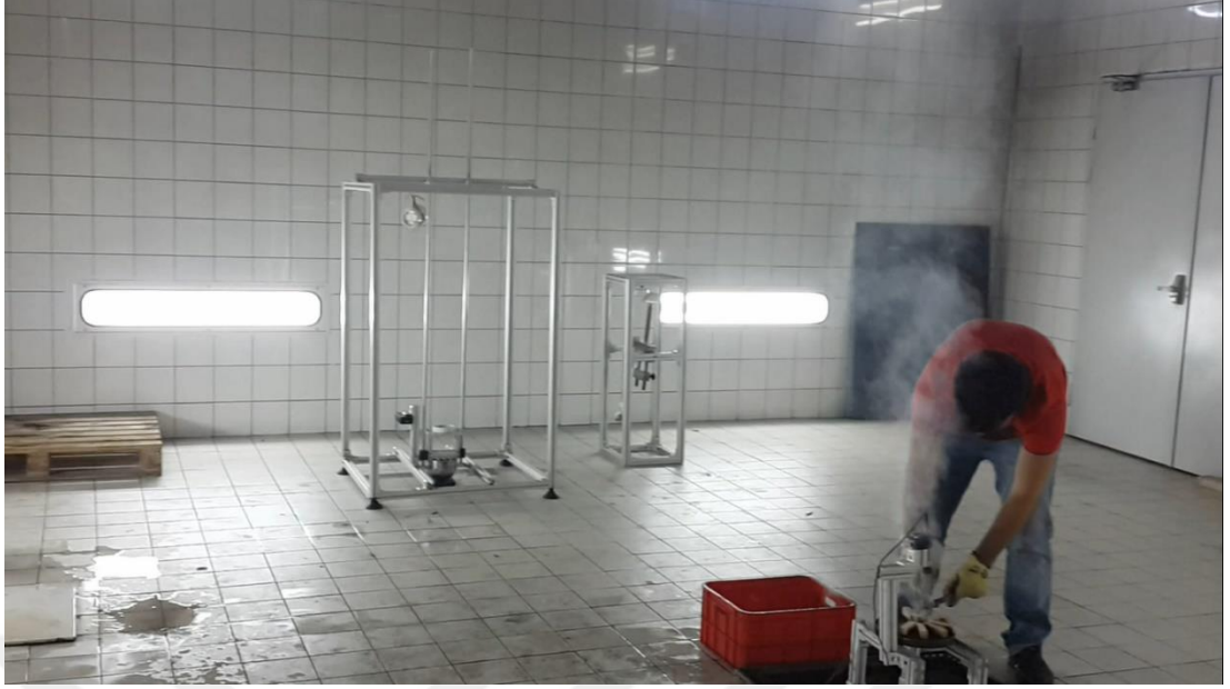
Resim 57- Odunların Pense Yardımıyla Su Kovasına Konulması
