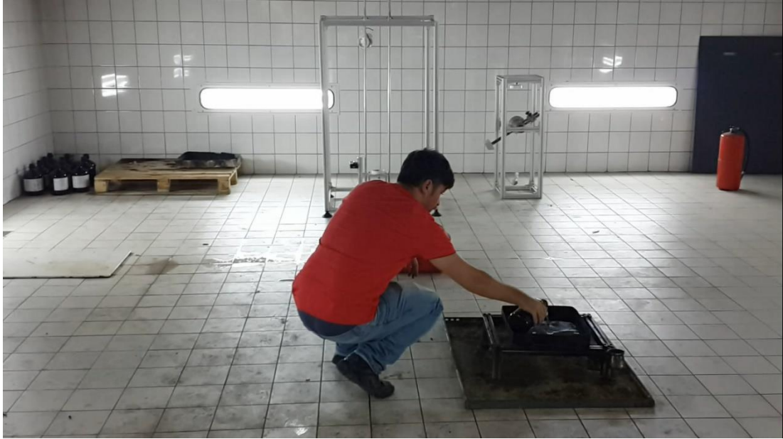
Resim 24- N-Heptan Karışımının Yangın Tavasına Dökülmesi
