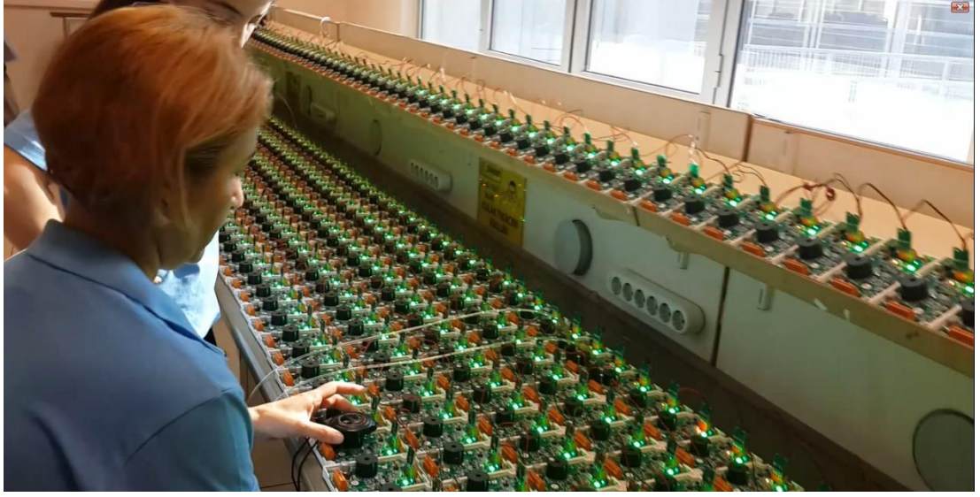
Resim 45- Kronometre ile Gazın Belirli sürelerde Tanıtılması
