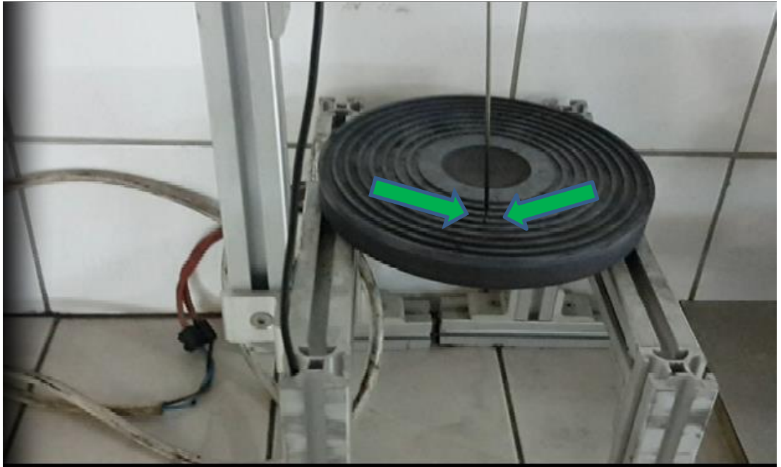
Resim 51- Odun Test Makinası Isı Ölçer İğne Ucu
