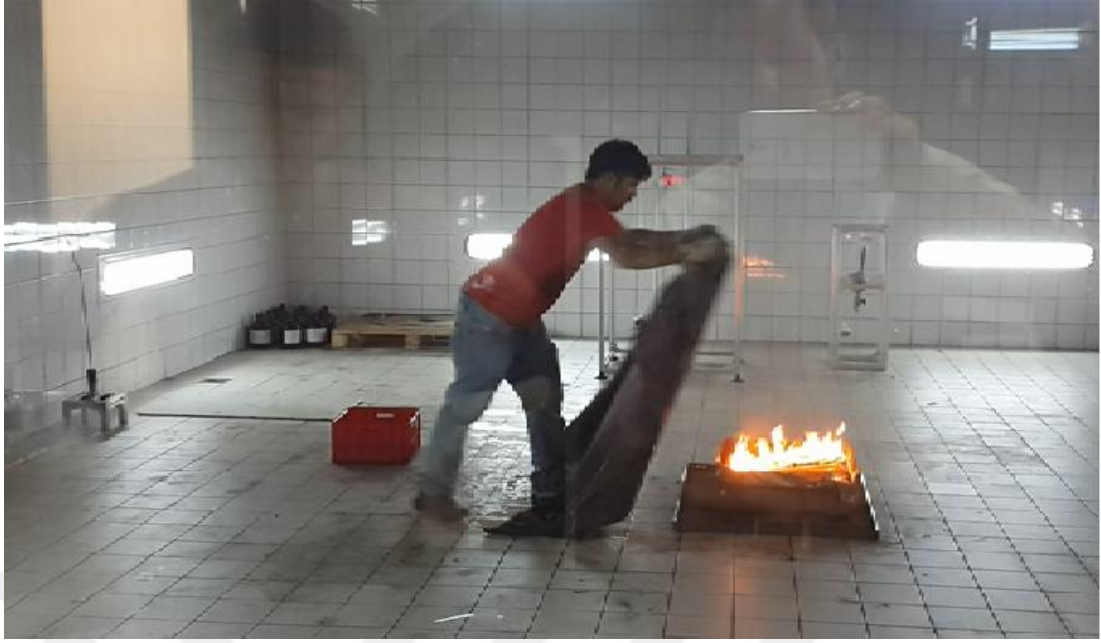
Resim 34- Poliüretan Maddenin Battaniye İle Söndürülmesi
