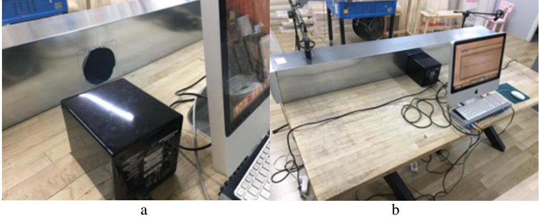
Şekil 2.7: (a) Ters gürültü hoparlörü için hazırlanan boşluk, (b) Hoparlör konumlandırma
