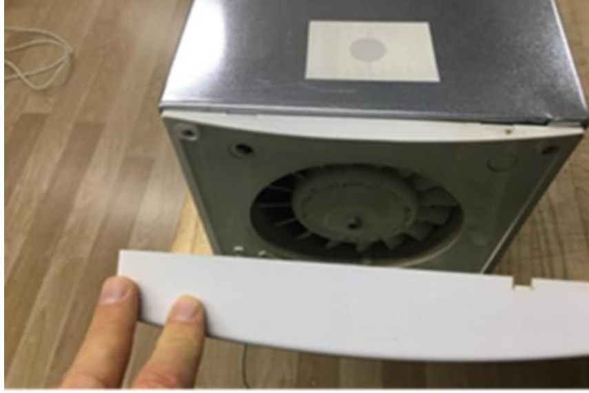
Şekil 2.5: Galvaniz havalandırma kanalına monte edilmiş fan motoru
