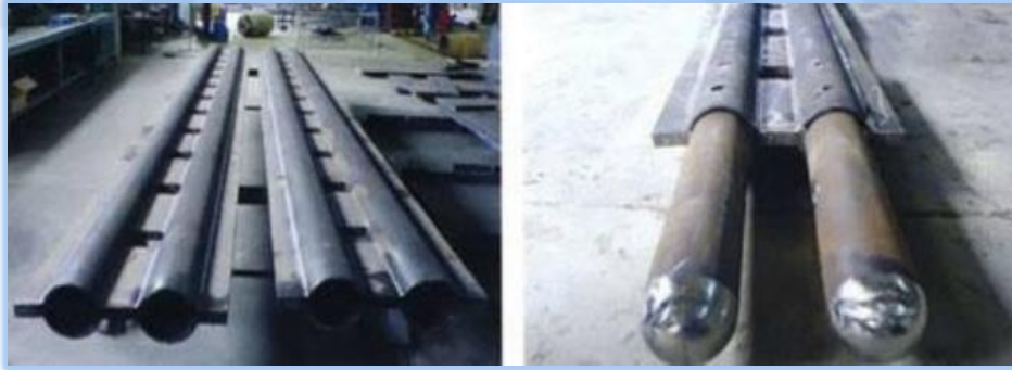
Şekil 2. 23: Durdurucular - Diyafram Duvar
