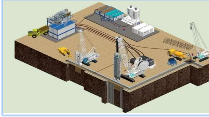
Şekil 2. 28: Diyafram Duvar Uygulamasının Genel İlerleyişi
