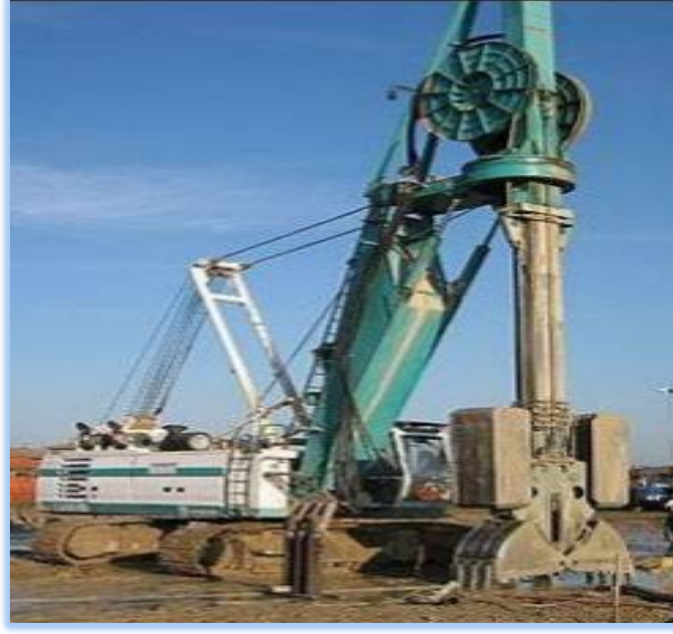
Şekil 2. 21: Kelly'e Montelenmiş Kepçe Ağzı - Boom Üzerindedir
