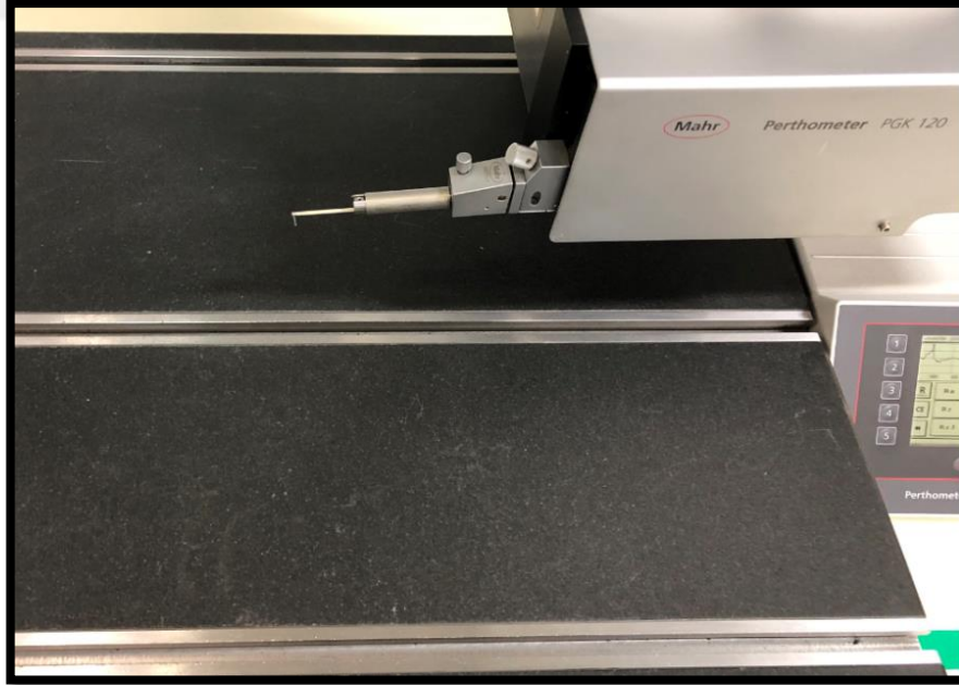
Şekil 3.19: Yüzey Pürüzlülüğü Cihazı Ölçüm Bölümü
