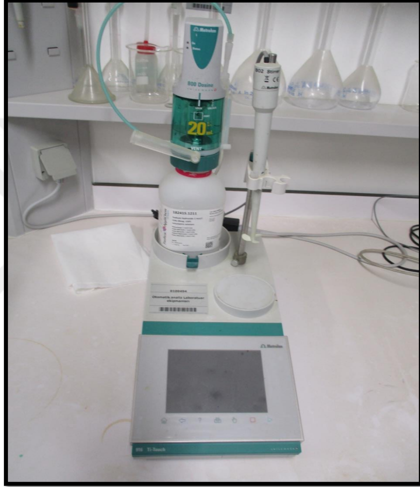
Şekil 3.29: Çözeltinin Hazırlanması İçin Kullanılan Titratör
