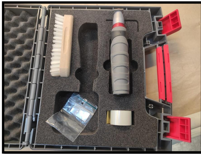
Şekil 3.36: Adezyon Testinde Çizik Atmak İçin Kullanılan Cross Cut Aleti
