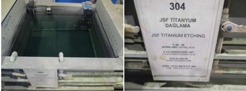
Şekil 3.11: Dağlama İşleminde Kullanılan Havuz ve Kimyasalın Bilgileri
