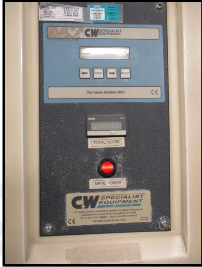
Şekil 3.27: Tuz Testi Kontrol Paneli
