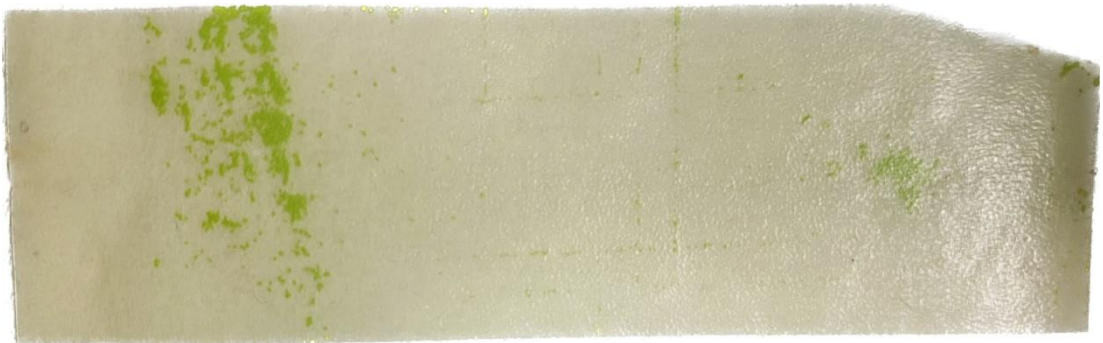
Şekil 4.10: Kaplamasız Numuneden Çekilen Bant Üzerinde Kalan Astar Artıkları
