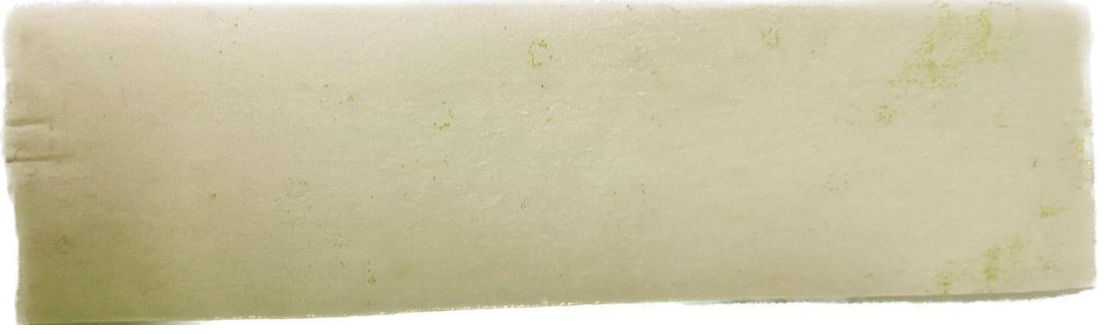
Şekil 4.11: Sol-Jel Kaplamalı Numuneden Çekilen Bant Üzerinde Kalan Astar Artıkları
