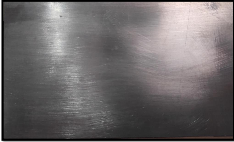
Şekil A.3: İşlemsiz Kupon Tuz Testi Öncesi
