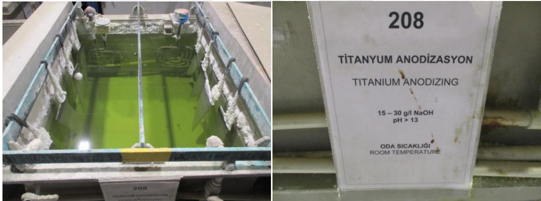
Şekil 3.13: Titanyum Anodizasyonu Banyosu ve Kimyasal Bilgileri
