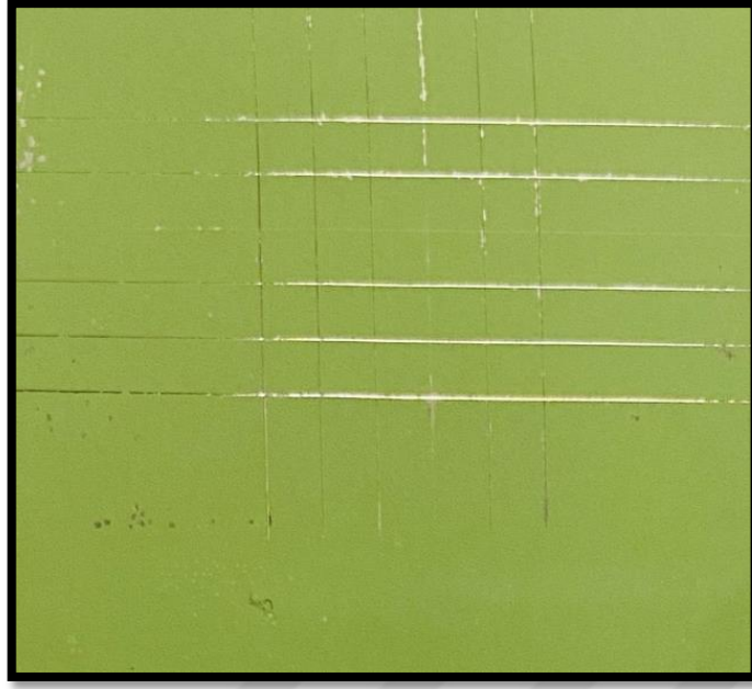
Şekil 4.8: Kaplamasız Numunenin Yaş Çizikli Adezyon Testi Sonrası Görüntüsü
