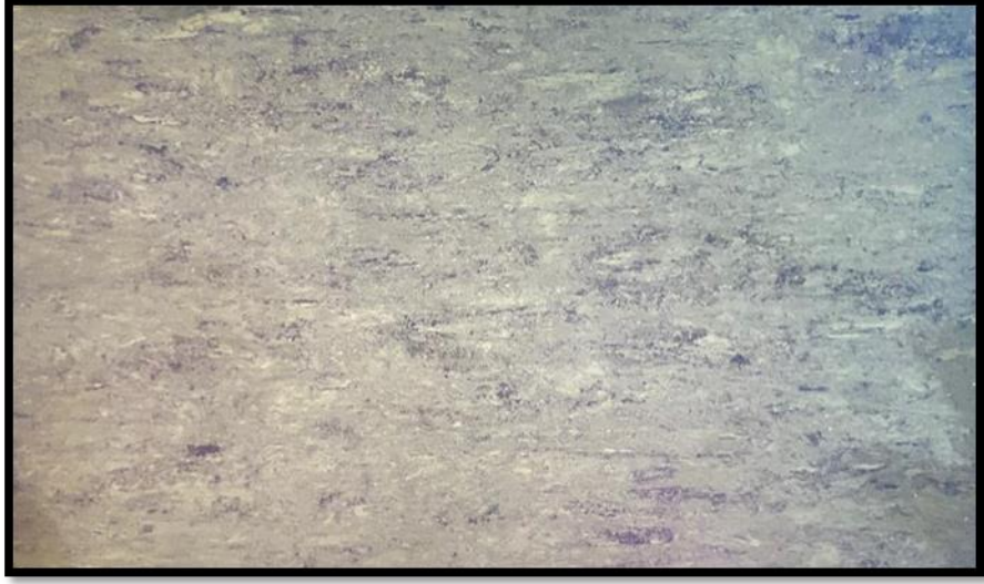
Şekil A.6: Anodizasyon Kaplamalı Kupon Tuz Testi Sonrası
