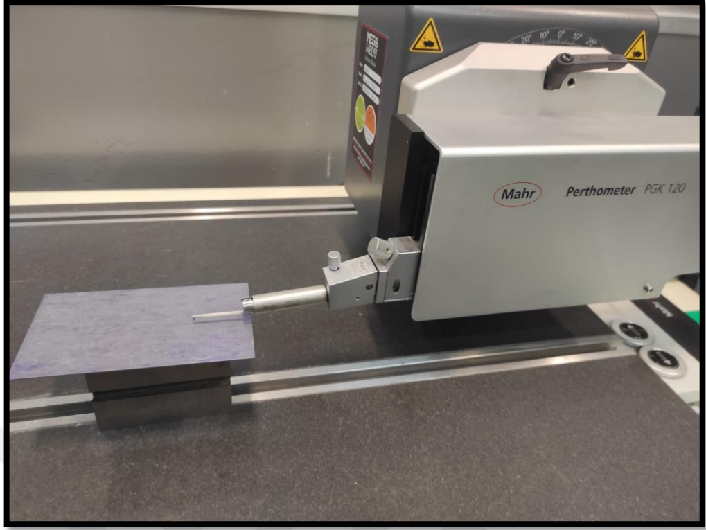
Şekil 3.31: Parça Üzerindeki YüzeY Pürüzlülüklerinin Tespit Edilmesi
