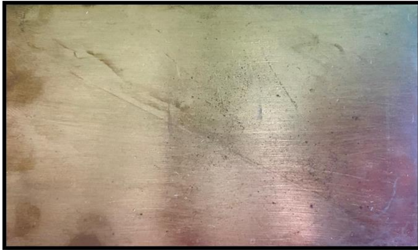
Şekil A.5: Sol-Jel Kaplamalı Kupon Tuz Testi Sonrası
