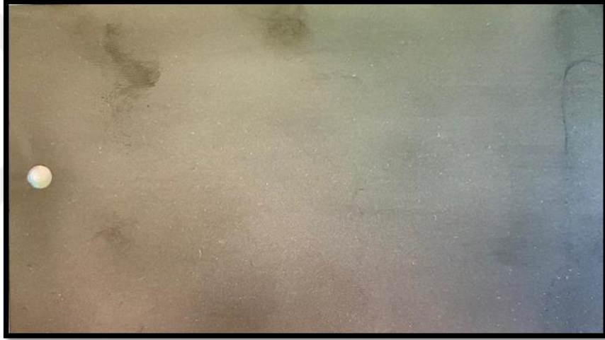
Şekil A.4: Sol-Jel Kaplamalı Kupon Tuz Testi Sonrası
