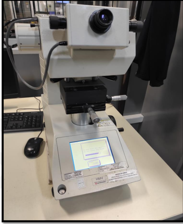
Şekil 3.33: Test Parçasının Mikro Sertliğinin Tespit Edilmesi
