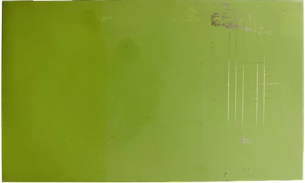
Şekil F.2: Kaplamasız Kuponun Adezyon Testi Sonrası Görüntüsü
