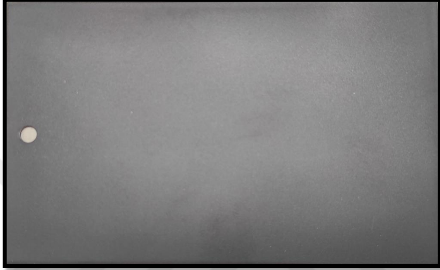
Şekil A.1: Sol-Jel Kaplamalı Kupon Tuz Testi Öncesi
