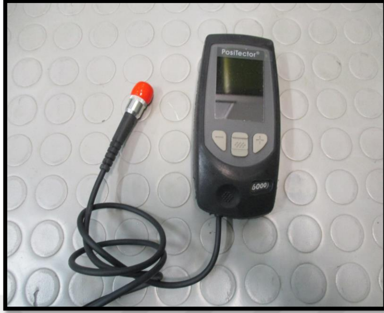
Şekil 3.24: Kaplama Kalınlığı Ölçüm Cihazı
