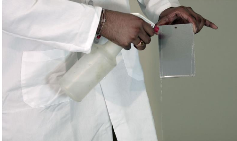
Şekil 3.10: Su Kırılımı Testi Uygulaması
