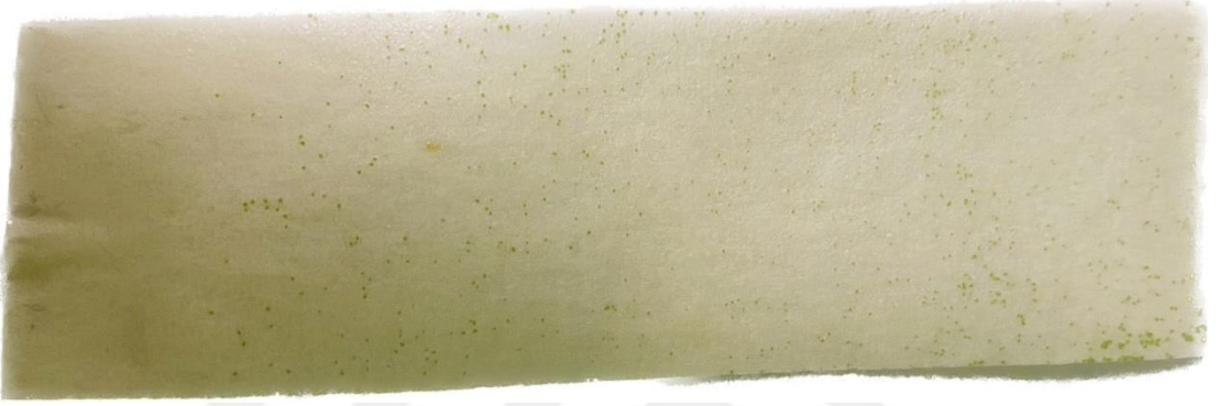
Şekil 4.12: Anodizasyon Kaplamalı Numuneden Çekilen Bant Üzerinde Kalan Astar Artıkları
