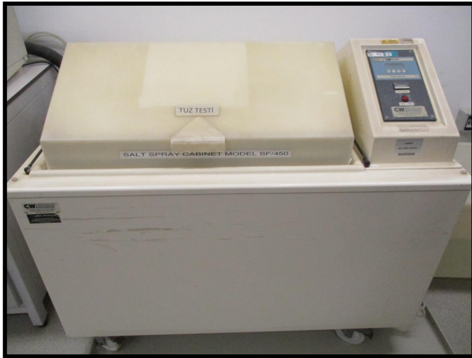
Şekil 3.26: Tuz Testi İçin Kullanılan Cihaz
