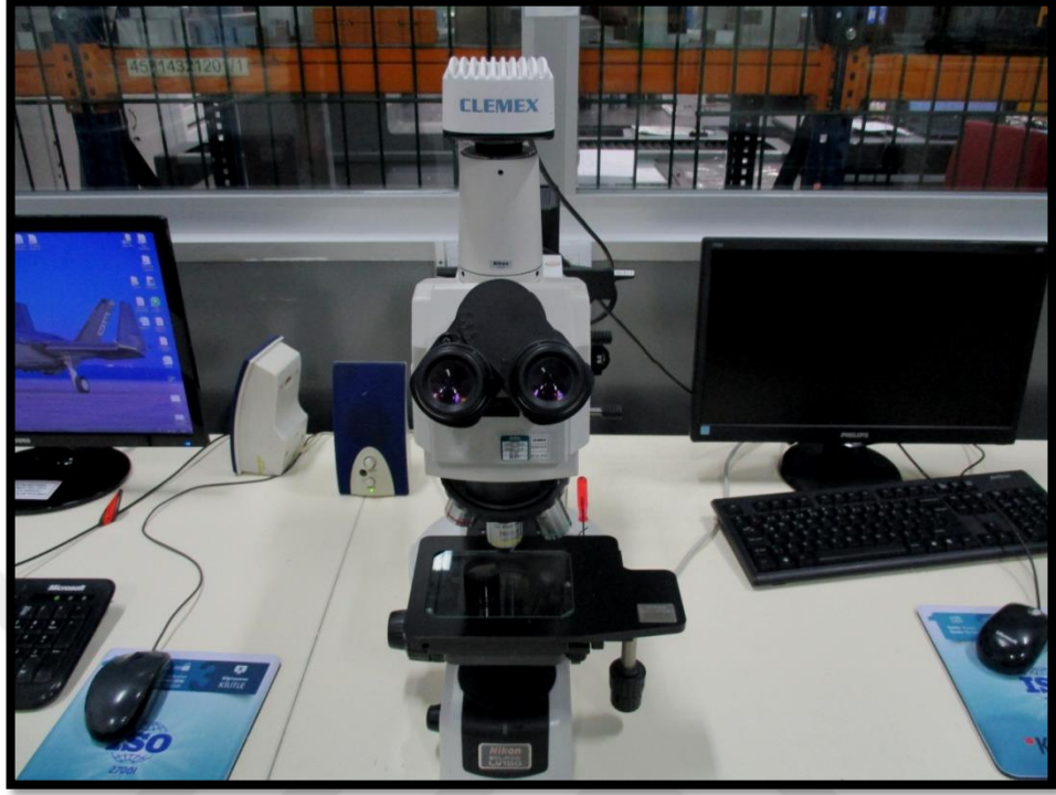
Şekil 3.35: Test Parçasının Görüntüleri Clemex Optik Mikroskop ile Alınmıştır
