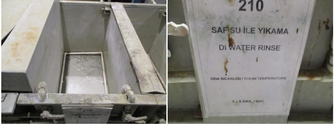
Şekil 3.12: Saf Su İle Yıkama İşleminde Kullanılan Havuz ve Bilgileri
