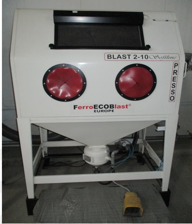
Şekil 3.6: Ferro ECOBlast Manuel Kumlama Tezgahı
