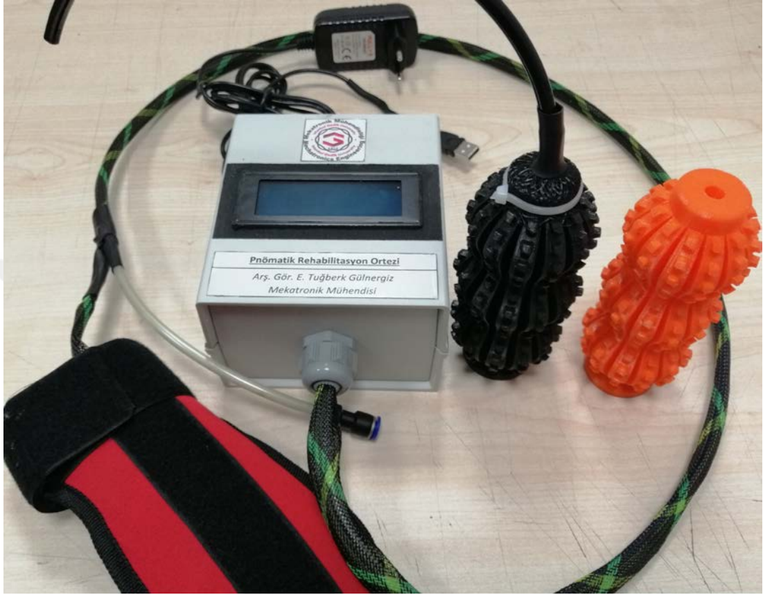
Şekil 5.1 : Yapay Kas Pnömatik Rehabilitasyon Ortezi ve Kontrol Sistemi
