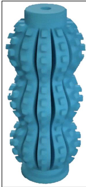
Şekil 3.6 : Katmanlı İmalata Hazır Yapay Kas Pnömatik Rehabilitasyon Ortezi
