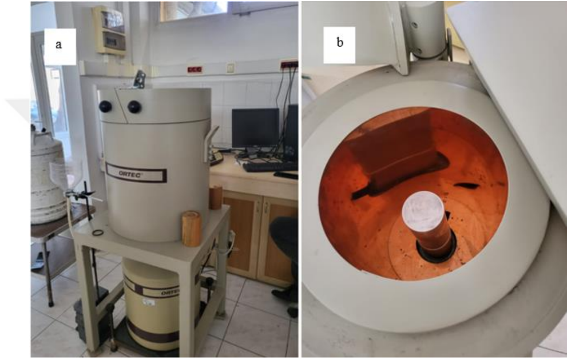
Şekil 5.16: Nötron Kaynağı Sayım Sistemi ve Gama Spektrometresinin a) Dıştan, b) Üstten Görünüşü
