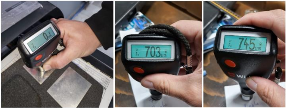
Şekil 5.12: Kalınlık Ölçme Cihazı Kalibrasyon İşlemi ve Örnek Ölçümlerinin Görüntüsü
