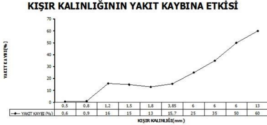
Şekil 5.7: Kışır tabakası kalınlığının yakıt kaybına olan etkisi
