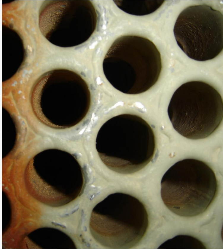
Şekil 5.9: Kazan suyundaki silikata ( \text{SiO}_2 ) bağlı olarak oluşan camsı kıvrık tabakası
