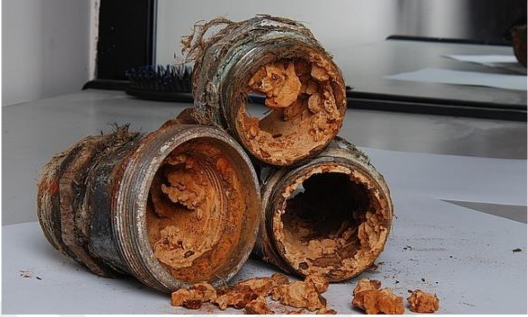
Şekil 5.5: Buhar kazanlarında oluşan kışır tabakası örneği
