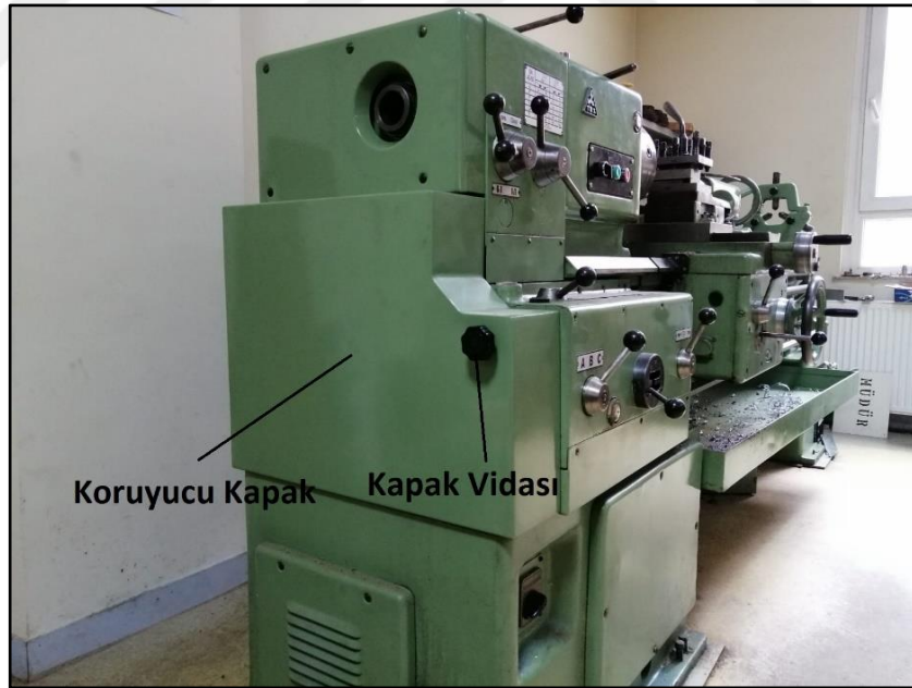
Şekil 2.16 : Torna Tezgâhında Koruyucu Mahfaza
