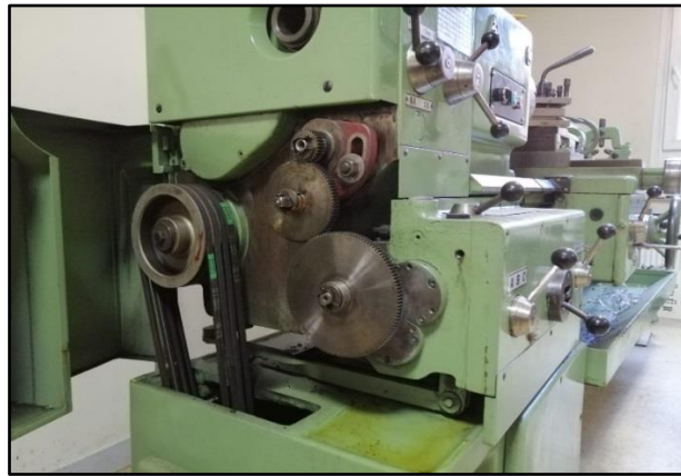
Şekil 2.11 : Torna Tezgâhında Aktarma Organları (Kayış Kasnak ve Dişliler)
