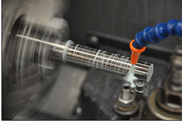
Şekil 2. 30 : Torna Tezgahında Soğutma Sıvısı Kullanımı
