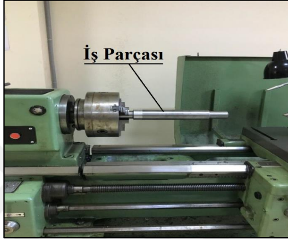
Şekil 2.21: Uzun ve Hatalı Bağlanmış İş Parçası
