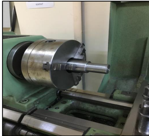
Şekil 2.20 : Kısa ve Emniyetli Bağlanmış İş Parçası
