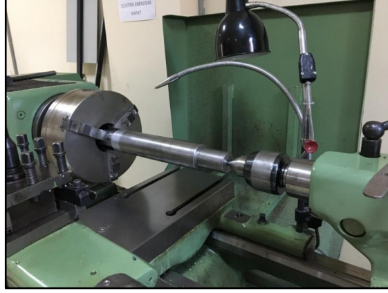
Şekil 2.22 : Ayna Punta Arasında Güvenli Bağlanmış İş Parçası
