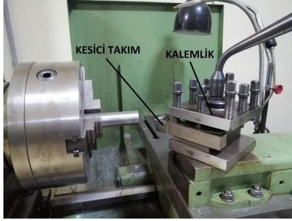
Şekil 2.10 : Kesici Takım ve Kalemlik
