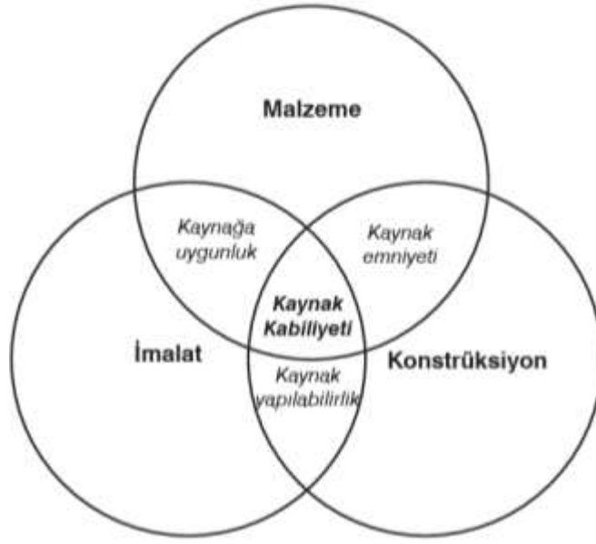
Şekil 3.17: Metallerin Kaynak Kabiliyetinin Temel Faktörler ile İlişkisi
