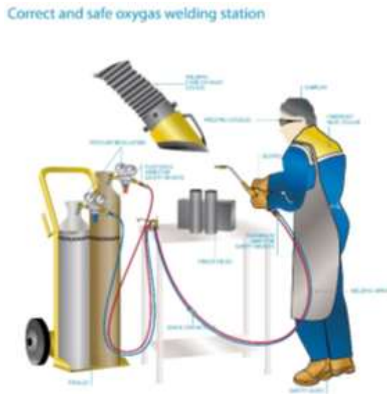
Şekil 3.8: Oksi-Asetilen Gaz Ergitme Kaynak Yöntemi
