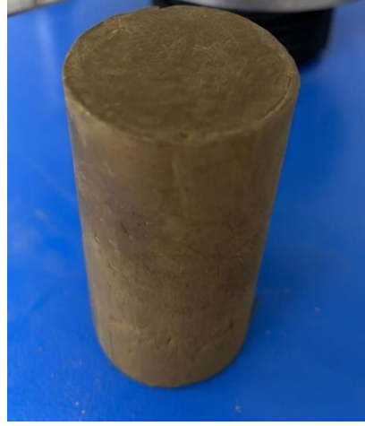
Şekil 2.12: Serbest Basınç Deneyleri İçin Hazırlanan Tipik Numune
