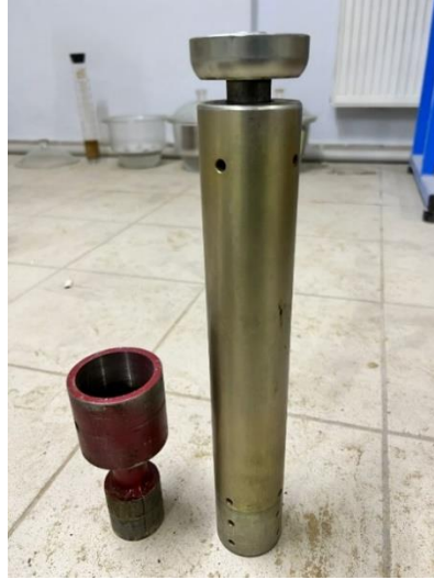
Şekil 2.11: Numuneleri Sıkıştırma İşleminde Kullanılan Aparat ve Standart Proctor Tokmağı
