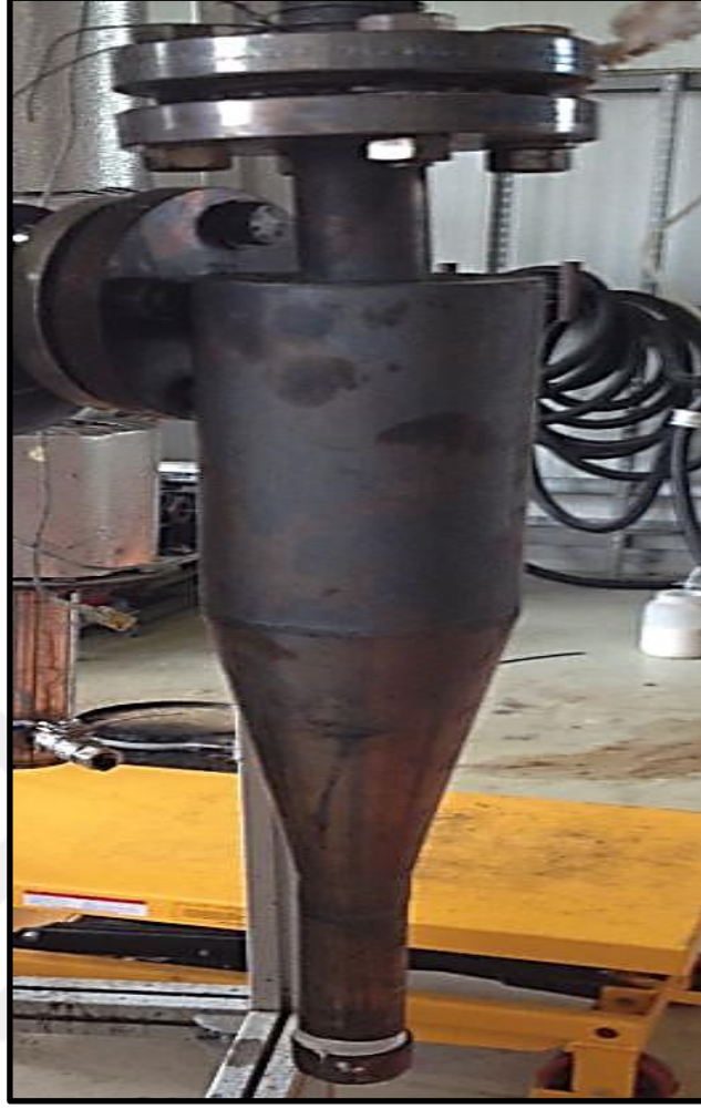
Resim 2: Revizyon sonucu üretilen siklon
