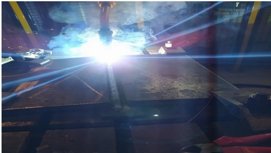
Şekil 10. 7: ELCOR M 80 Ni Metal Özlü Telin Kaynağında Bir Görüntü
