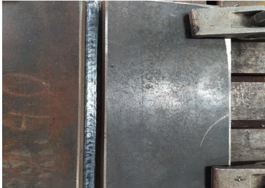
Şekil 10. 4: Pasolar Arası Bir Kaynak Dikişinin Görüntüsü
