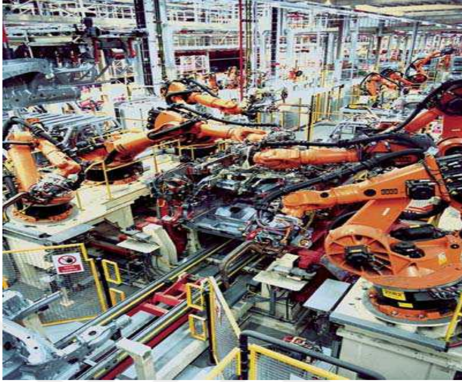
Şekil 5. 1: Kaynaklı Birleştirmede Sanayi Robotlarının Kullanımı[14]
