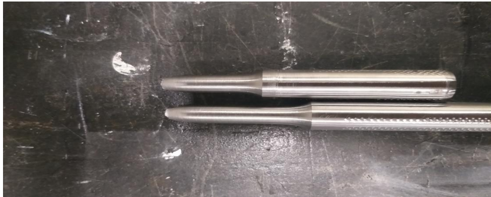
Şekil 12. 6:Çekme Testi Sonucunda Test Numunelerinin Görüntüsü
