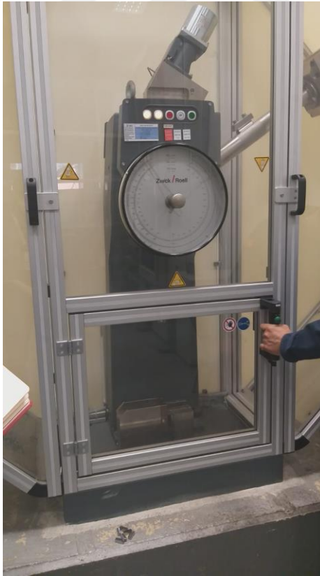
Şekil 11. 4: Çentik Test Deneyi Esnasında Bir Görüntü
