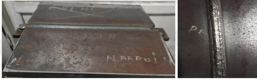
Şekil 12. 1:ELCOR R 81 Ni Rutil Özlü Tel ve ELCOR M 80 Ni Metal Özlü Tel Kaynağı Görüntüsü
