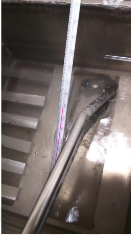
Şekil 11. 3: Test Numunelerini -30^{\circ}\text{C} , -40^{\circ}\text{C} ve -50^{\circ}\text{C} 'ye Soğutulması
