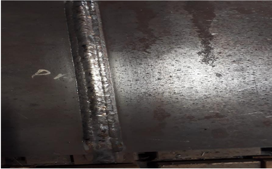
Şekil 10. 9: ELCOR M 80 Ni Metal Özlü Tel Kaynağının Dikiş Görüntüsü
