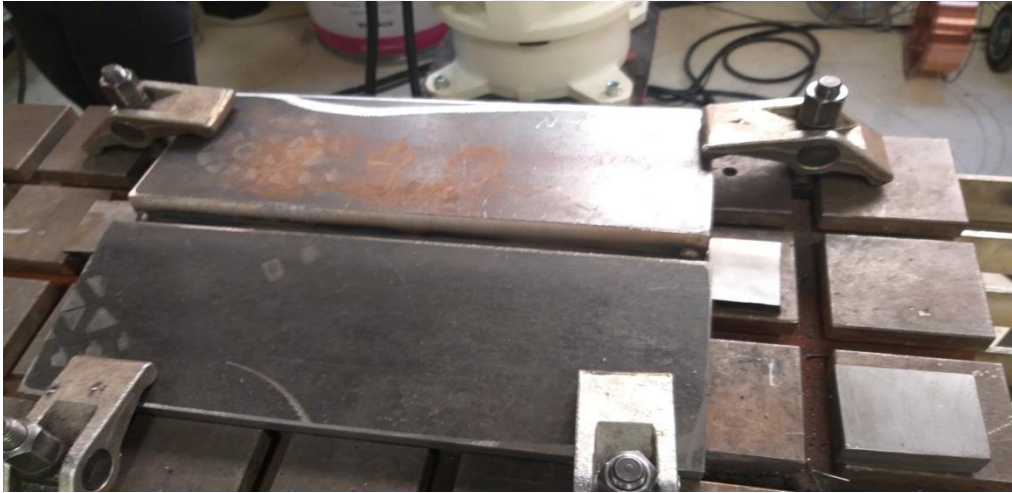
Şekil 10. 1: Test Parçasının Aparatlarla Sabit Tuturulması
