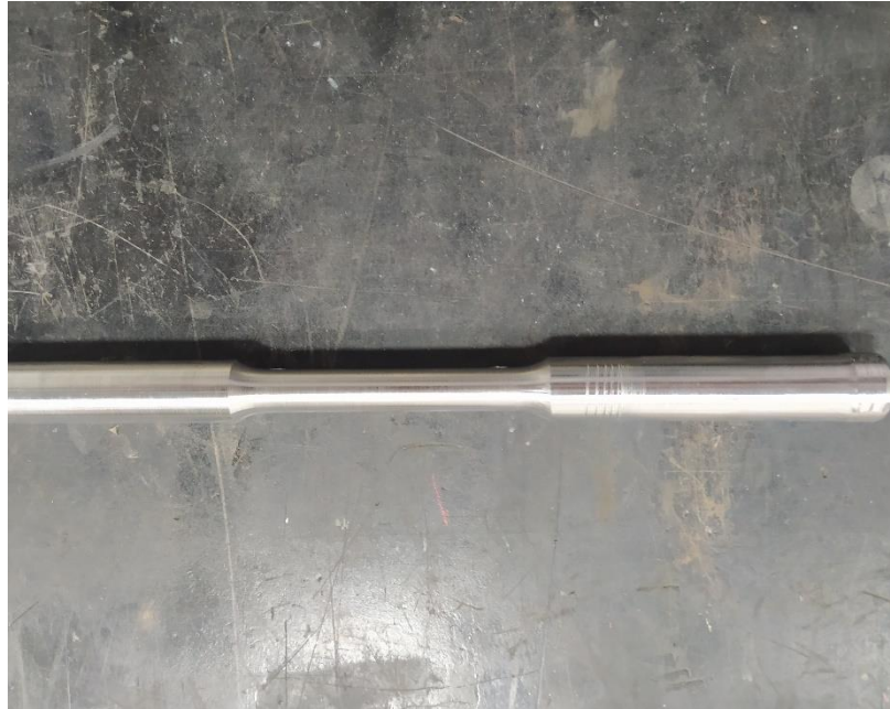
Şekil 11. 6:Her İki Numune İçinde Hazırlanan Çekme Test Numunesi
