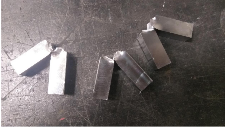
Şekil 12. 3: ELCOR R 81 Ni Rutil ve ELCOR M 80 Ni Metal Özlü Tel kaynağının Çentik Testi Deneyi Sonrası Numune Görünümü
