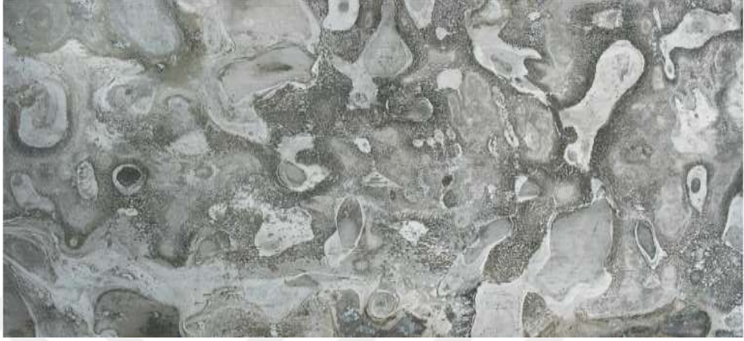
Şekil 6.1: Korozyona Uğramış Alüminyum Alaşım Yüzey
