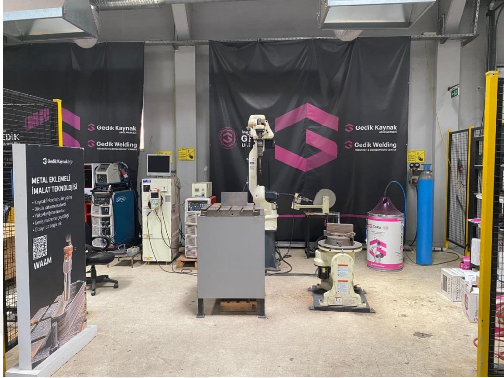
Şekil 7.12: WAAM ile Türbin Kanadı Üretimi Sırasında Kullanılan Üretim Hücresi
