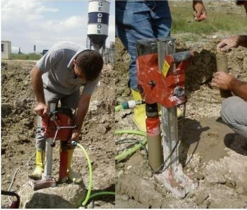
Şekil 2.31 : Jet grout kolonu karot alınması (Doğanışık, 2010).
