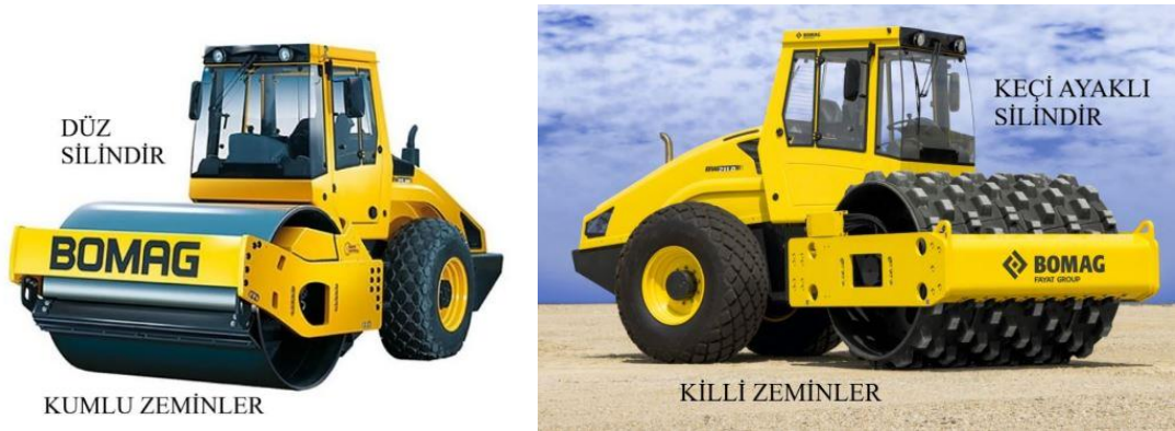
Şekil 2.4 : Zemin tipine göre kullanılan silindir tipleri (Url-1, 2020).
