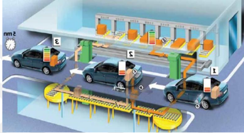
Şekil 2.11: Batarya Deęiştirme İstasyonu (Quick Drop)
