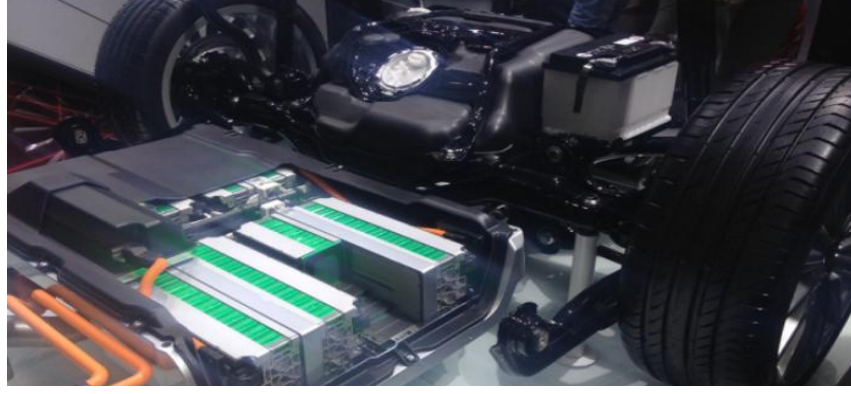
Şekil 2.15: Elektrikli Araçların Bataryalarının Şasi Üzerinde Yerleştirilmiş Hali
