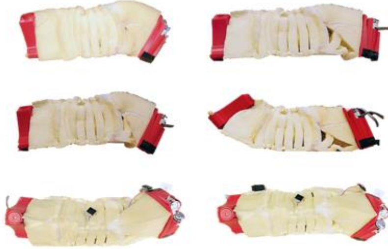
Şekil 2.3: SquMABot çok yönlü hareket yapıları
