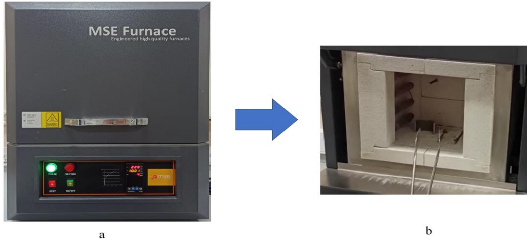
Şekil 4.7: Ni-Ti ŞBA tellere ısıl işlem uygulaması
