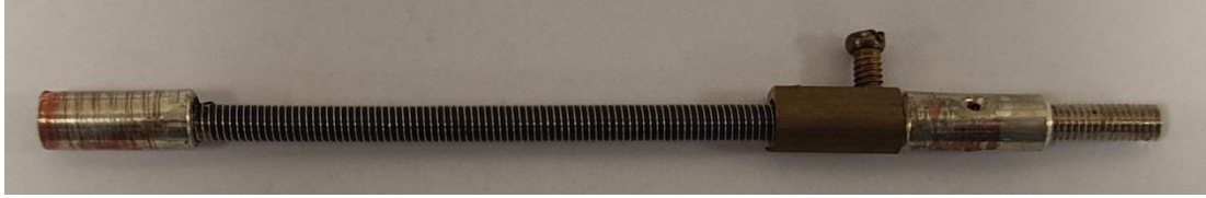
Şekil 4.6: Ni-Ti ŞBA malzemenin kalıplanmış son hali
