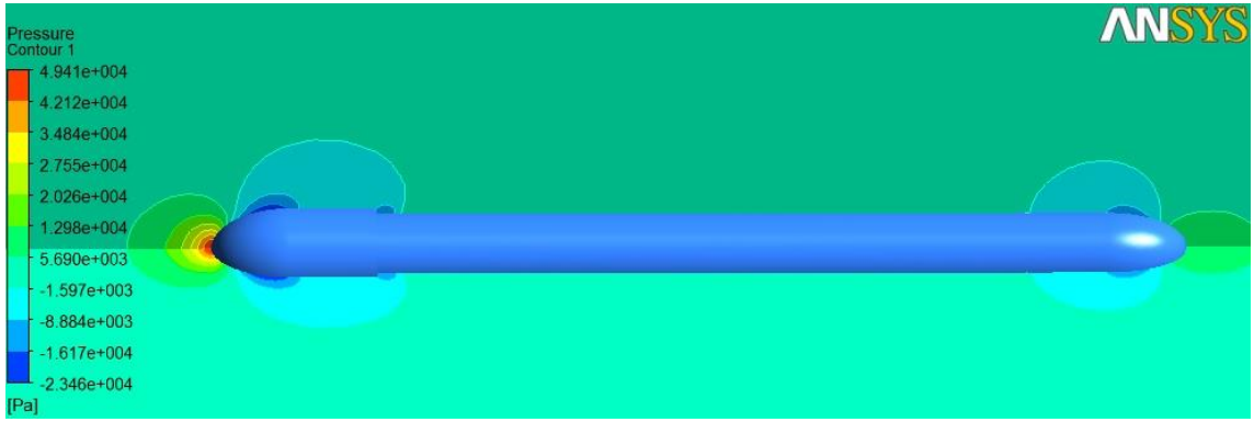
Şekil 161_ V=5 m/sn için step arkası türbülans oluşumu
