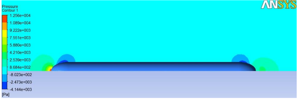
Şekil 182_ V=5 m/sn için basınç değerlerinin değişimi
