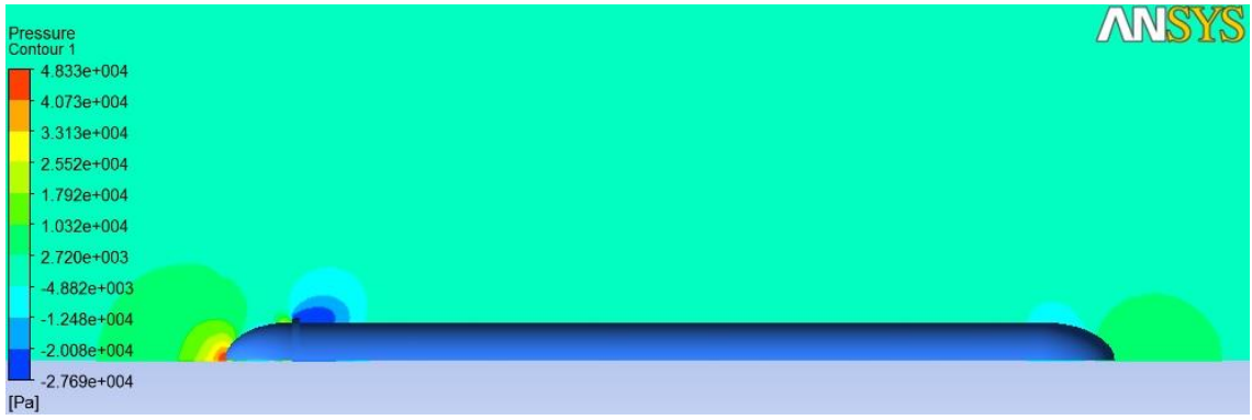
Şekil 42_ V=10 m/sn için basınç değerlerinin değişimi
