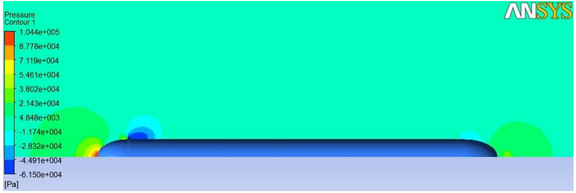
Şekil 46_ V=15 m/sn için basınç değerlerinin değişimi
