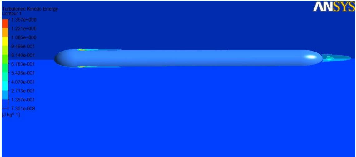
Şekil 111_ V=5 m/sn için türbülans kinetik enerji değerlerinin değişimi
