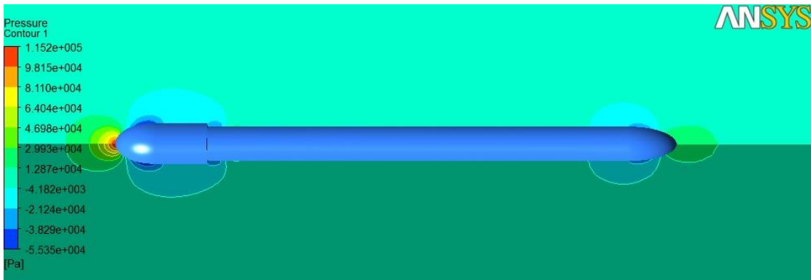
Şekil 177_ V=10 m/sn için step arkası türbülans oluşumu
