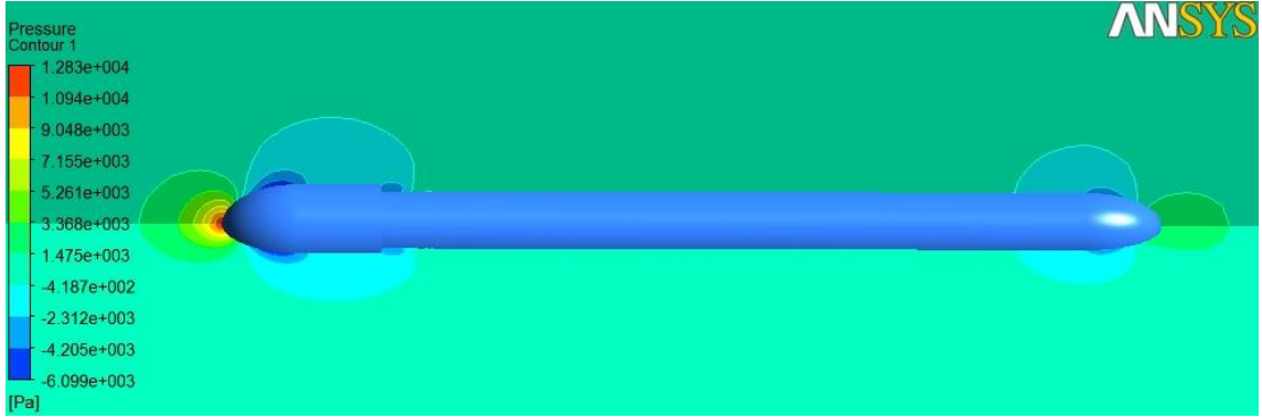
Şekil 170_ V=5 m/sn için basınç değerlerinin değişimi
