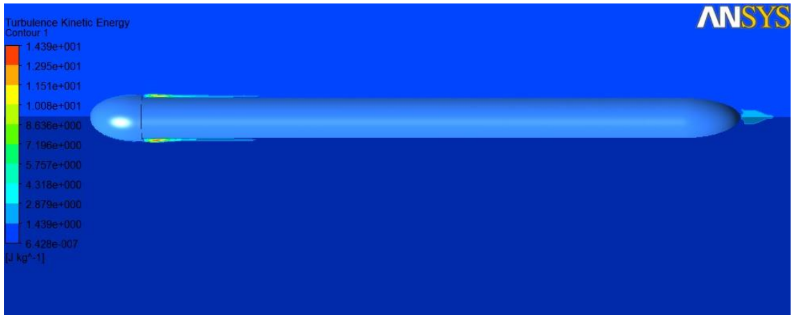
Şekil 143_ V=15 m/sn için türbülans kinetik enerji değerlerinin değişimi
