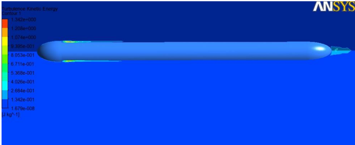
Şekil 123_ V=5 m/sn için türbülans kinetik enerji değerlerinin değişimi
