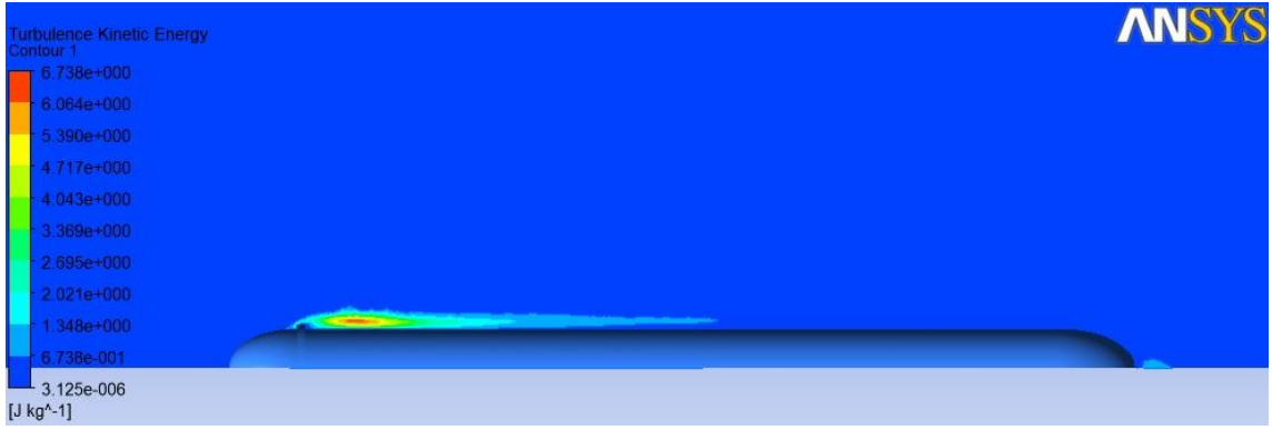
Şekil 43_ V=10 m/sn için türbülans kinetik enerji değerlerinin değişimi
