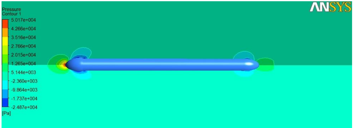
Şekil 126_ V=10 m/sn için basınç değerlerinin değişimi
