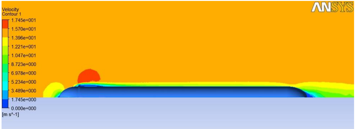
Şekil 48_ V=15 m/sn için hız değerlerinin değişimi
