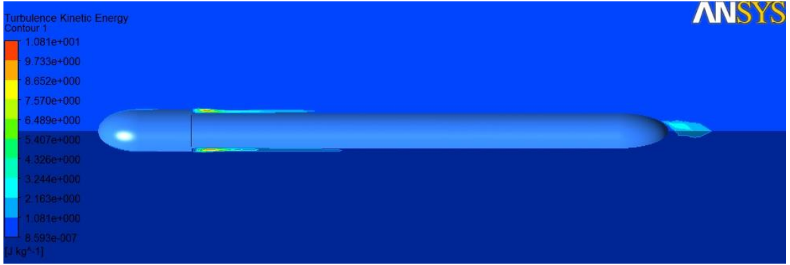
Şekil 179_ V=15 m/sn için türbülans kinetik enerji değerlerinin değişimi
