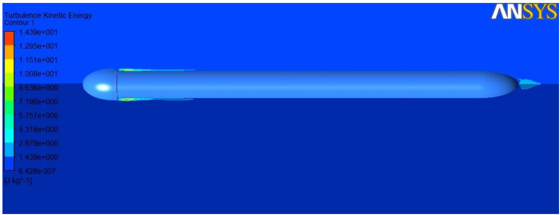
Şekil 131_ V=15 m/sn için türbülans kinetik enerji değerlerinin değişimi
