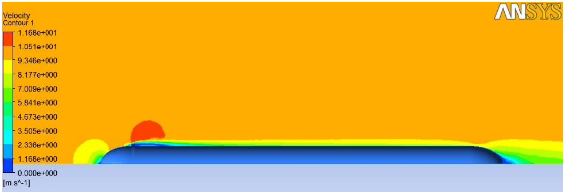
Şekil 44_ V=10 m/sn için hız değerlerinin değişimi
