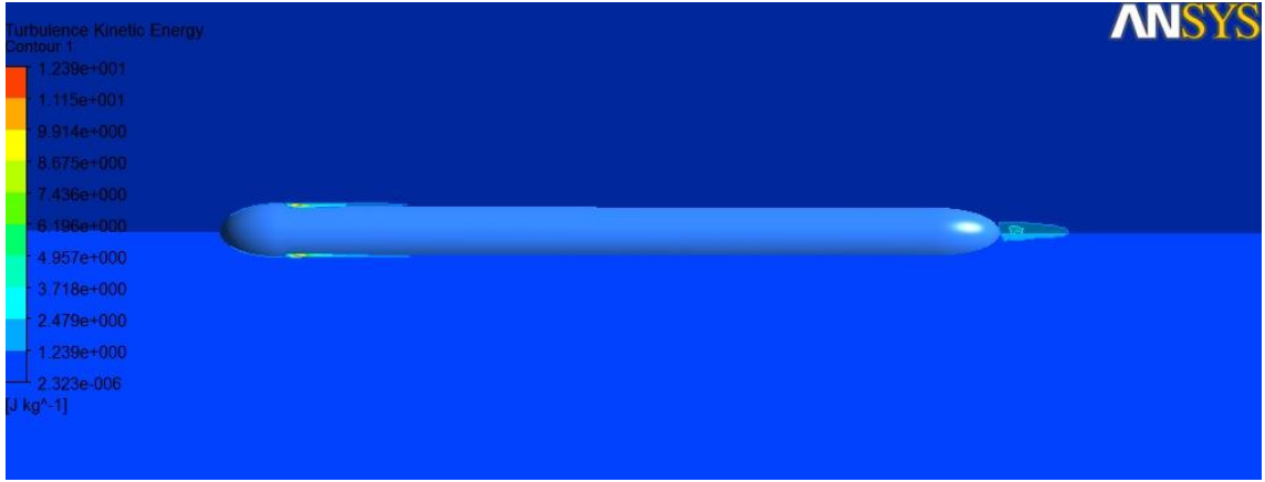
Şekil 119_ V=15 m/sn için türbülans kinetik enerji değerlerinin değişimi
