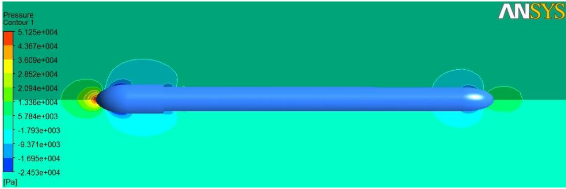
Şekil 173_ V=5 m/sn için step arkası türbülans oluşumu
