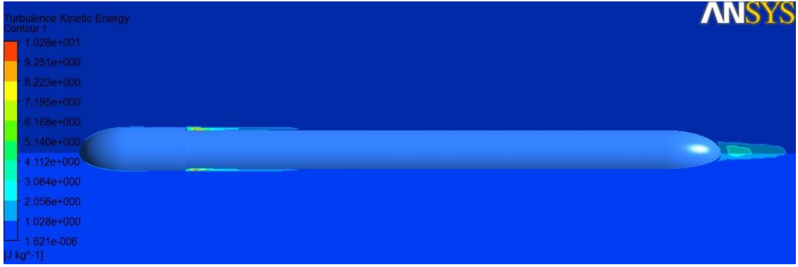
Şekil 155_ V=15 m/sn için türbülans kinetik enerji değerlerinin değişimi
