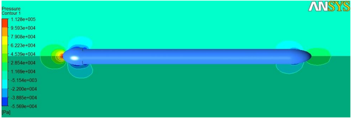
Şekil 130_ V=15 m/sn için basınç değerleri değişimi
