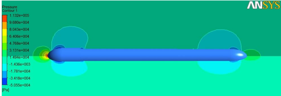
Şekil 153_ V=10 m/sn için step arkası türbülans oluşumu
