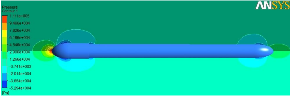
Şekil 165_ V=10 m/sn için step arkası türbülans oluşumu
