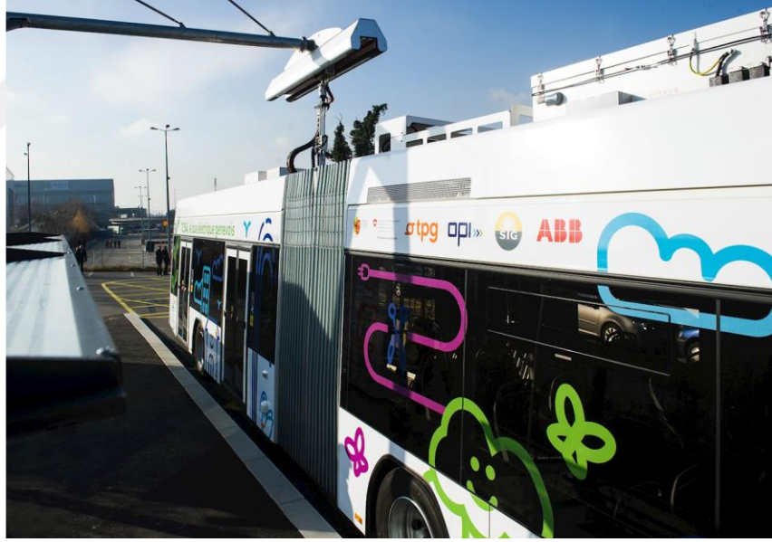
Şekil 3.2: Fırsat Şarjı İçin ABB Tarafından Sunulan Bir Flaş Şarj Cihazı [19]
