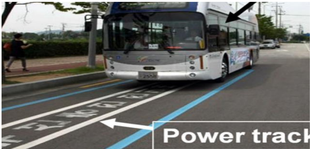
Şekil 3.4: Güney Kore Gumi Şehrindeki Kablosuz Şarj Sistemi [21]
