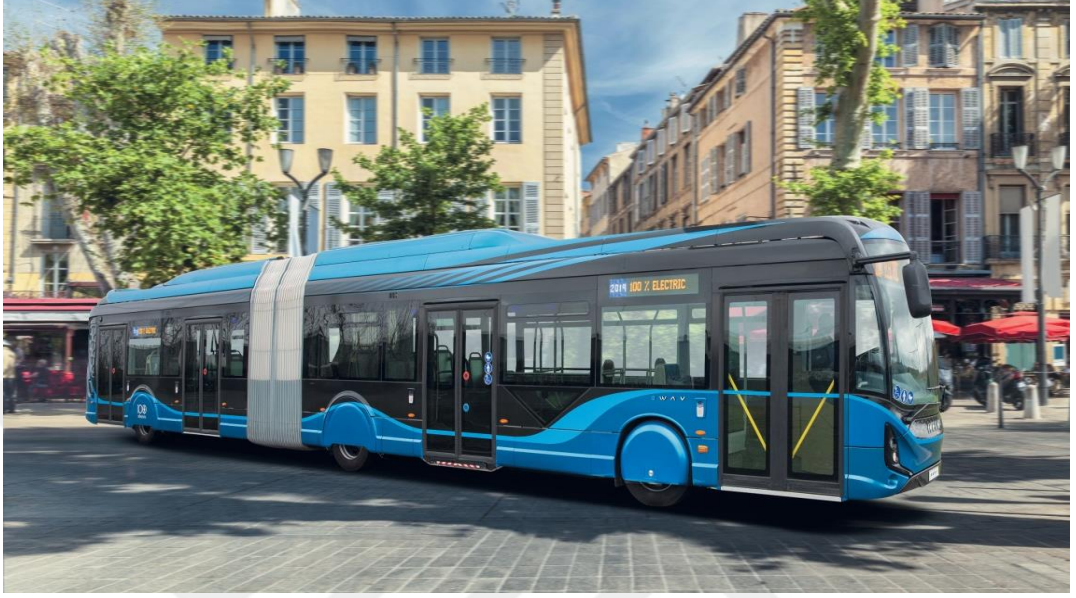
Şekil 2.5: Piyasada bulunan 18 metre mafsallı elektrikli otobüs[16]
