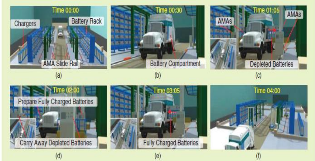
Şekil 7.1: Elektrikli Bir Kamyon İçin Pil Değiştirme İşleminin Altı Adımlı Bir Çizimi
