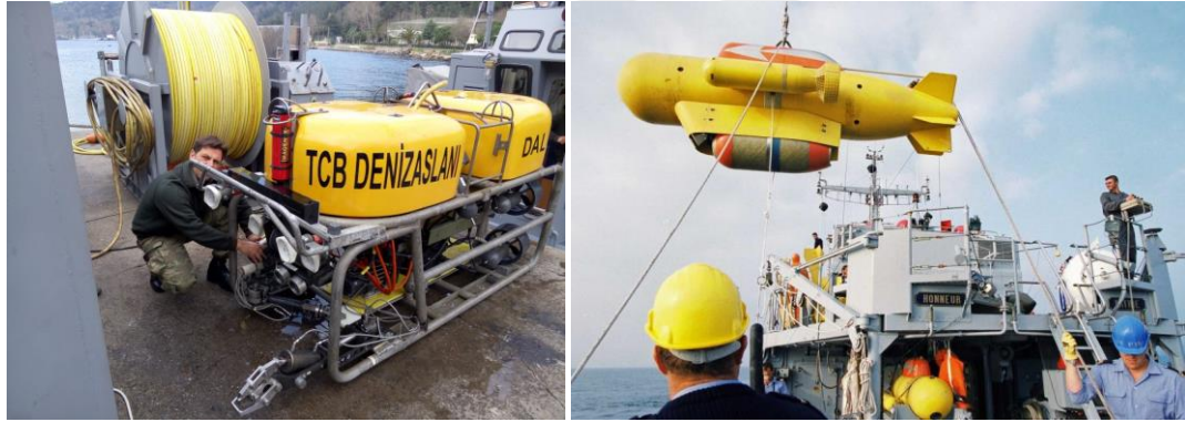
Şekil 2.3: İnsansız Su Altı Aracı TCB Deniz Aslanı (ROV) ve Mayın Avlama Aracı (PAP) Suya İnişi (URL-5, 2018)
