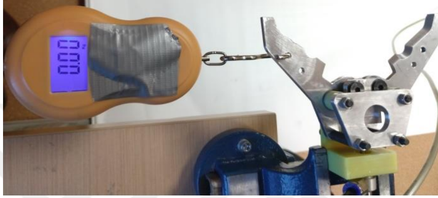
Şekil 4.9: Yük Hücresi İle Çekme Kuvveti Test Düzeneği
