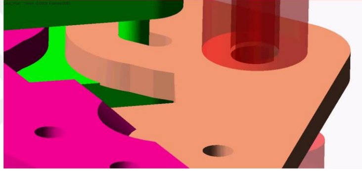
Şekil 3.20: Mafsall-2 Çevresinde Radyal Yönde Genişletilen Boşluk
