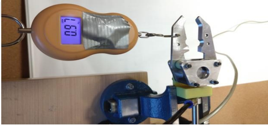
Şekil 4.10: Yük Hücresi İle Çekme Kuvveti Testi (0,8 MPa Akışkan Basınç Altında)
