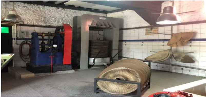
Resim 3: Zeytin hamuru konulan torbalarda sıkılma işlemi yapılan hidrolik pres
