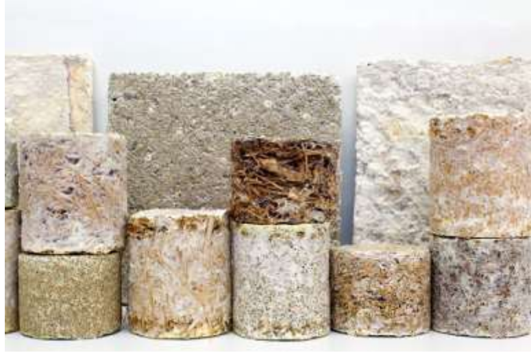
Şekil 2.11: Mevcut Organik Atıkların İnşaat Sektörüne Uygun Hale Getirilmiş Bir Malzeme Örneği Mycelium
