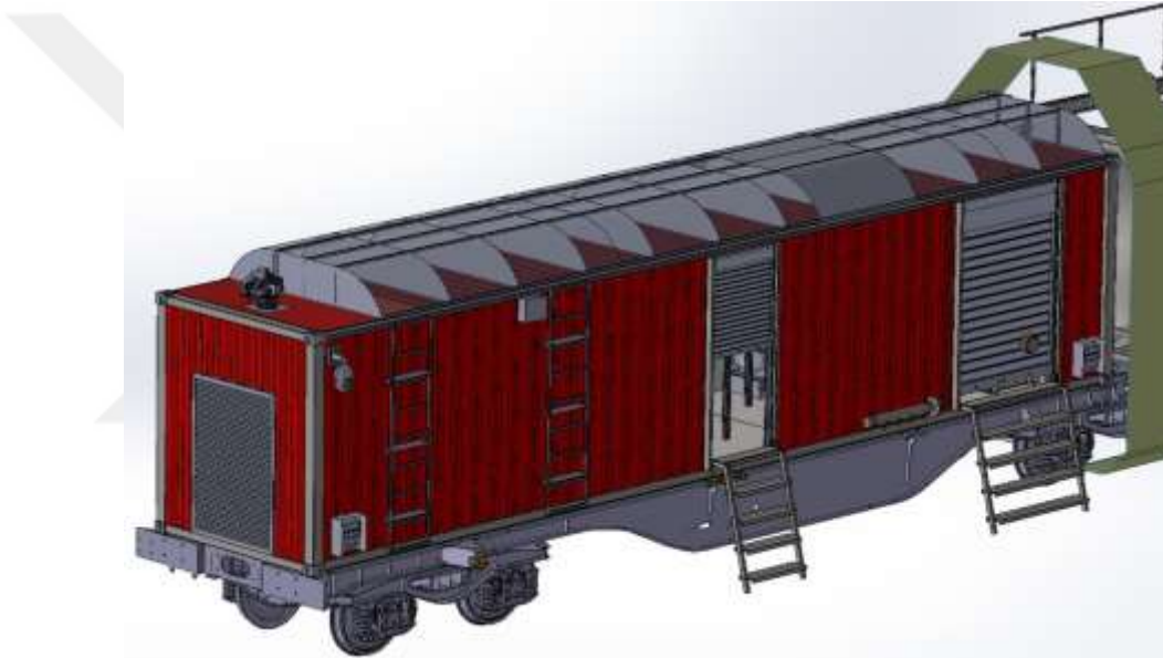
Şekil 4.1: Pompa ve Jeneratör Seti Konteyneri (GÜÇSET)
