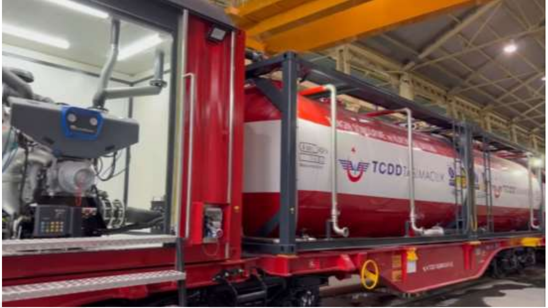
Şekil 4.4: Pompa ve Jeneratör Seti ve 20FT ISO Tank Konteynerler
