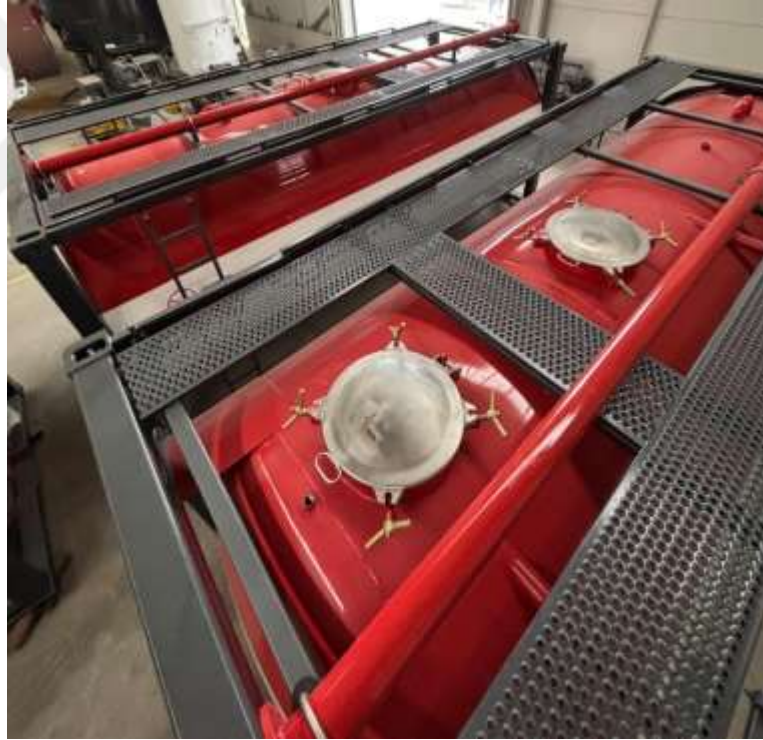
Şekil 4.10: ISO Tank Menhol ve Emniyetli Yürüyüş Hattı Görünümü
