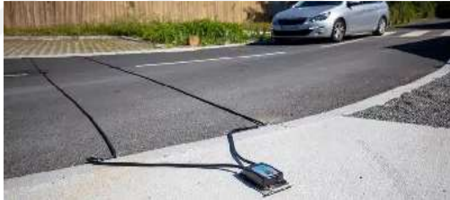
Şekil 2.2: Pnömatik Yol Tüpü
