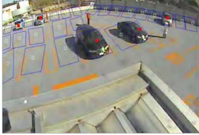
Şekil 2.21: Gözetim Kamerası ve FCM Sınıflandırıcısı Kullanarak Otoparkta Boş Park Yeri Tespiti
