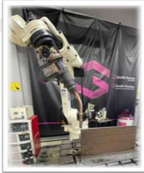
Şekil 5.1: ER110 WAAM Duvarı
