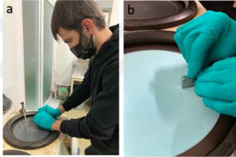
Şekil 5.6: Metalografik Numune Hazırlama İşlemleri a) Zımparalama b) Dağlama
