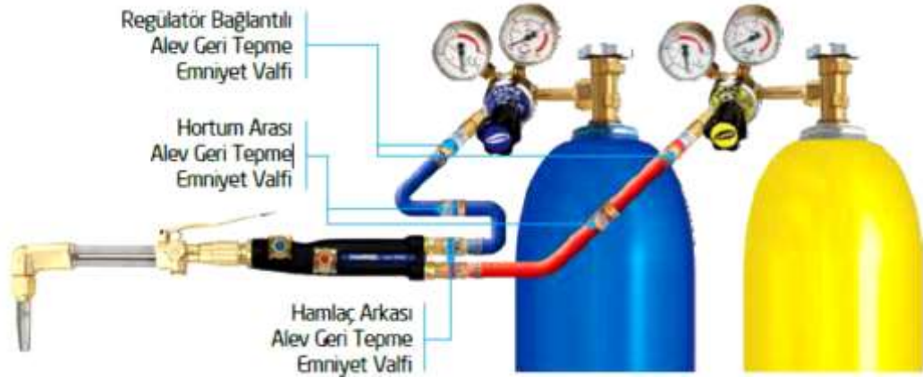
Şekil 2.31: Alev Geri Tepme Emniyet Tertibatı Kullanım Şeması
