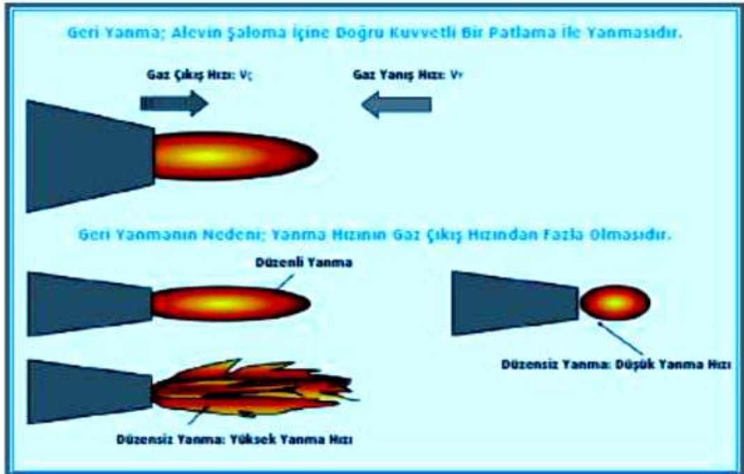
Şekil 2.30: Geri Yanmanın Şematik Gösterimi
