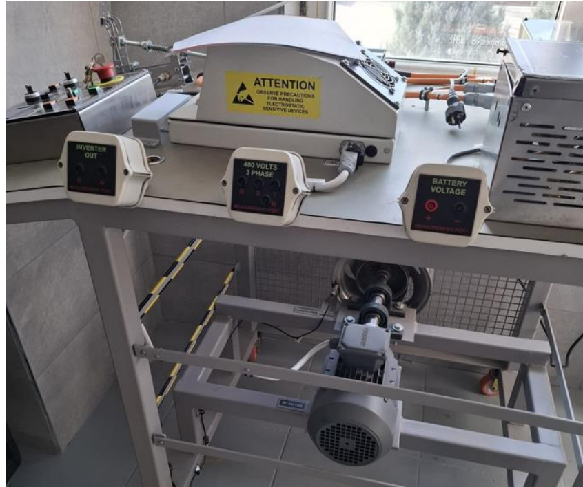
Şekil 2.3: 1.1 kW’lık Bir ASM’nin Elektrikli Araç Tahriği Deneyi
