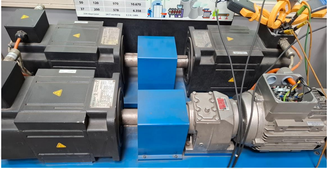
Şekil 2.12: Deney Düzeneği ve Redüktörün Yerleşimi
