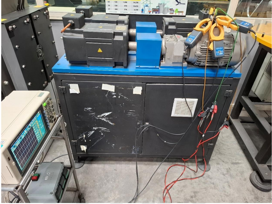
Şekil 2.10: ASM ve KMSM Deney Düzeneği
