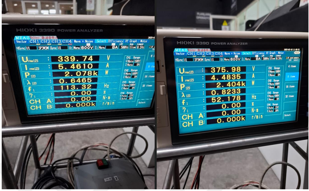
Şekil 2.13: KMSM Ölçüm Sonuçları (a) ve ASM Ölçüm Sonuçları (b)
