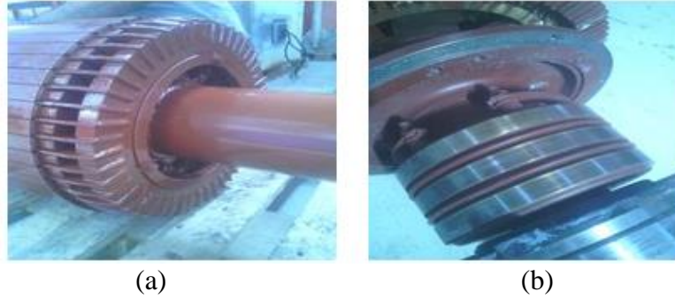
Şekil 2.2: ( a) Sincap Kafesli Rotor Yapısı (b) Bilezikli Rotor Yapısı [5]
