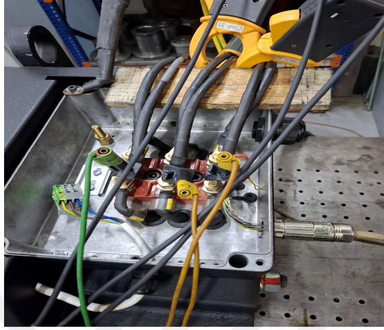
Şekil 3.3: Motor Ölçüm Bağlantıları
