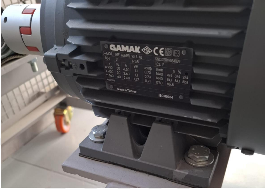
Şekil 2.4: Kullanılan ASM'nin Etiket Bilgileri
