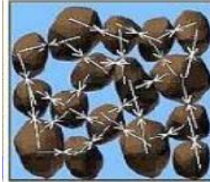
(b) zemin taneleri arasında kontak kuvvetleri
