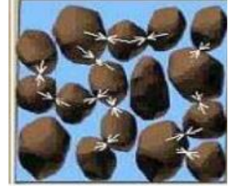
(c) sıvılaşma sonrasında zemin taneleri
