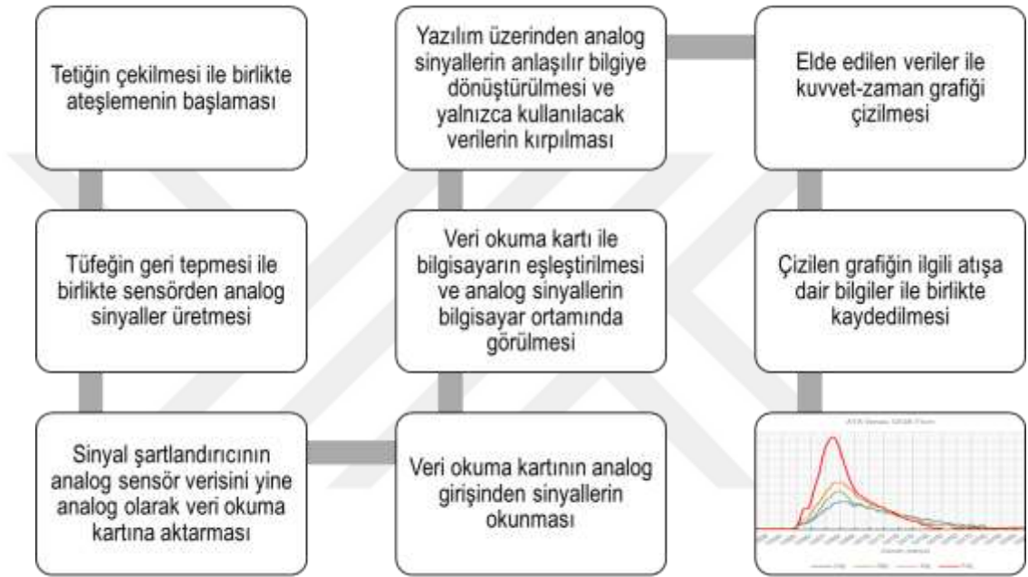
Şekil 4.27: Verilerin toplanması sürecinin akış şeması olarak gösterimi
