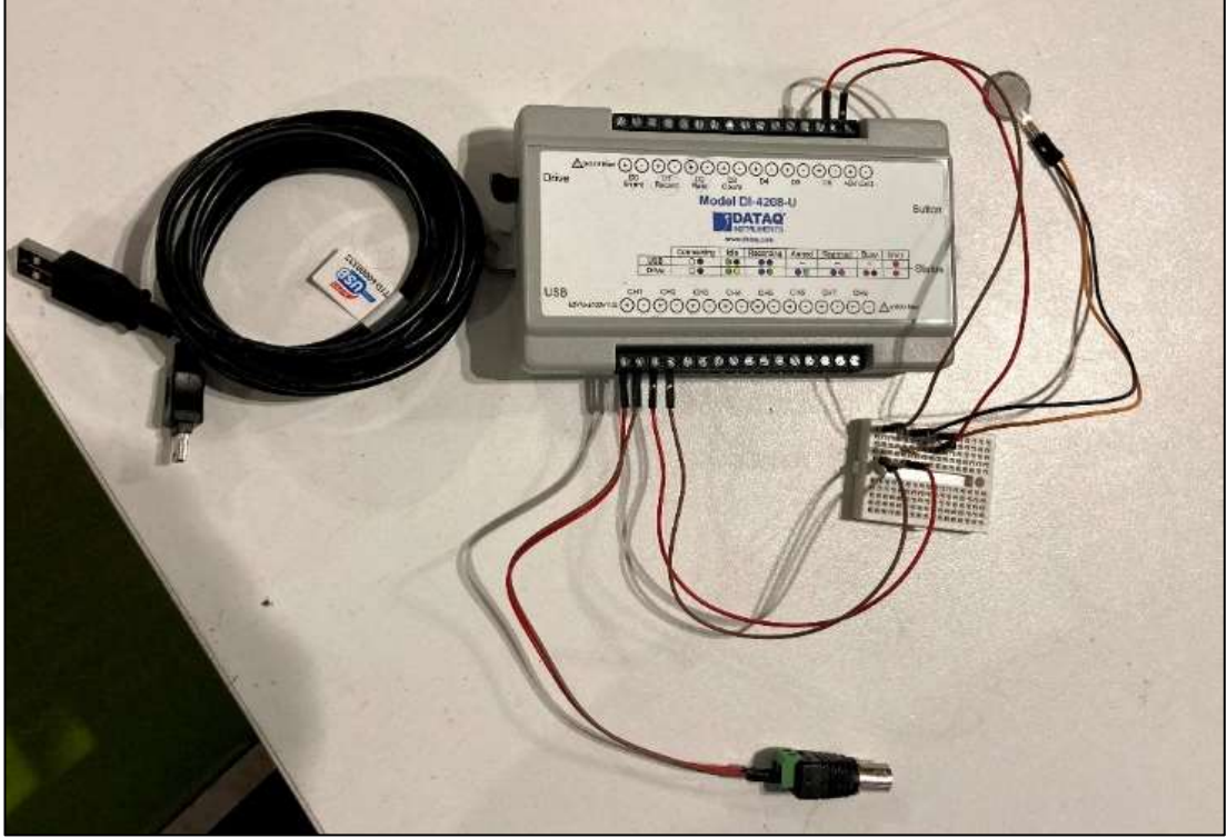
Şekil 4.3: Sensör temininden önce veri toplama sistemi bağlantılarının denenmesi
