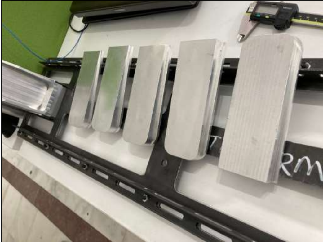
Şekil 4.13: Farklı tüfekler için tasarlanan omuzluk dayama parçaları
