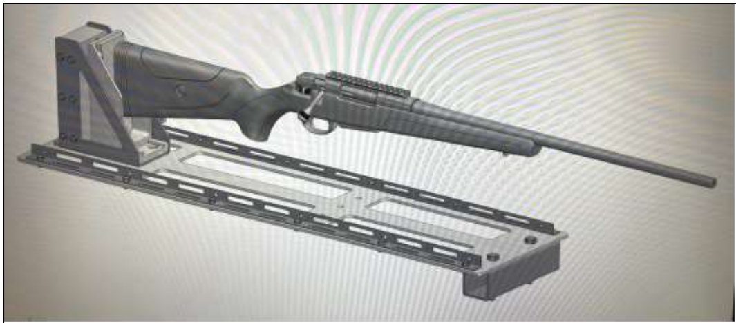
Şekil 4.8: Tüfek yerleştirilmiş hali ile atış aparatı tasarımı
