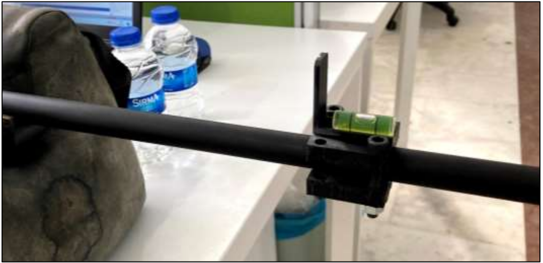
Şekil 4.20: Namlunun yere paralel olduğunu kontrol etmek için kullanılan aparat
