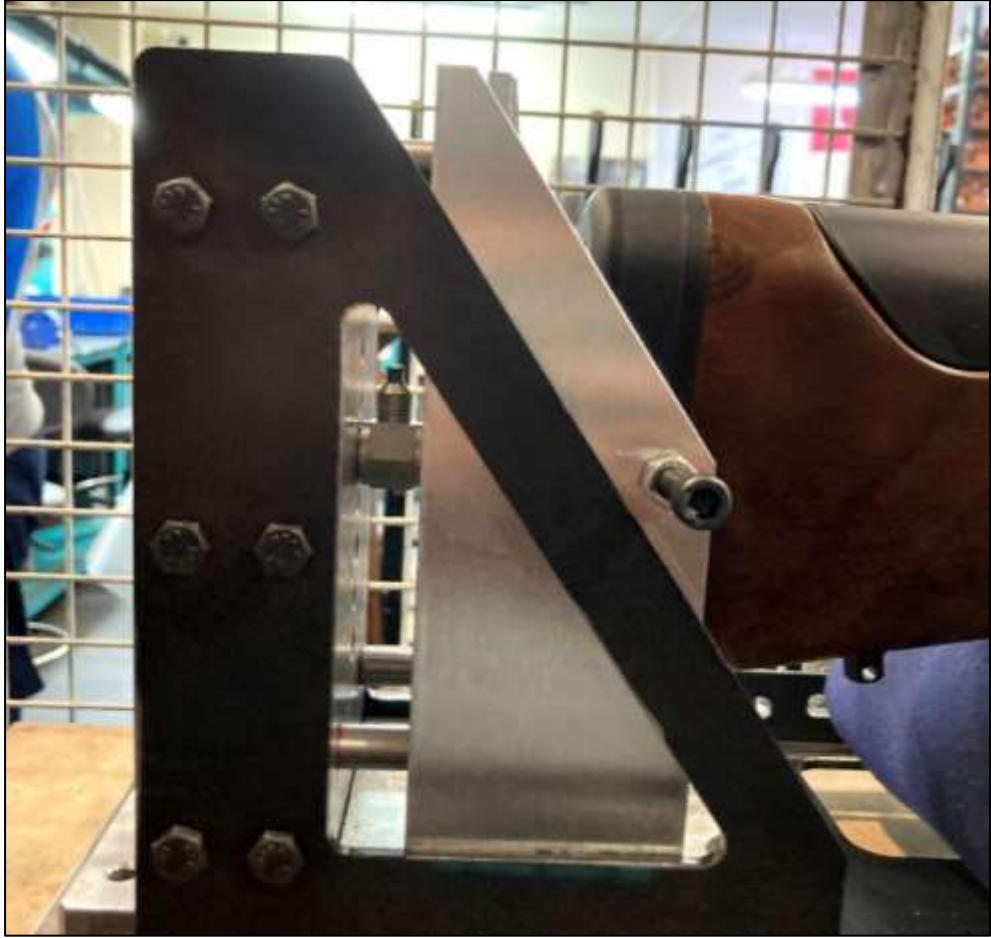
Şekil 4.24: Aparata yerleştirilen sensör
