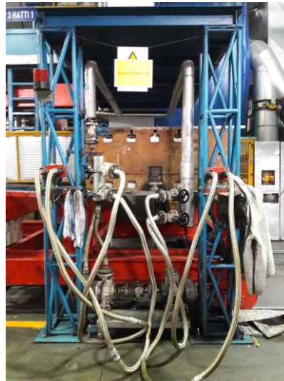
řekil 5.38: Vaka 3 De Anlatılan Ramak Kalanın Yařandığı Kızgın Yaę Hortumları
