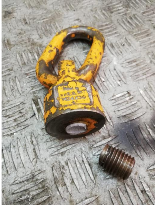
Şekil 5.48: Vaka 10 da Yaşanan Ramak Kaladaki Mapa Kırılması
