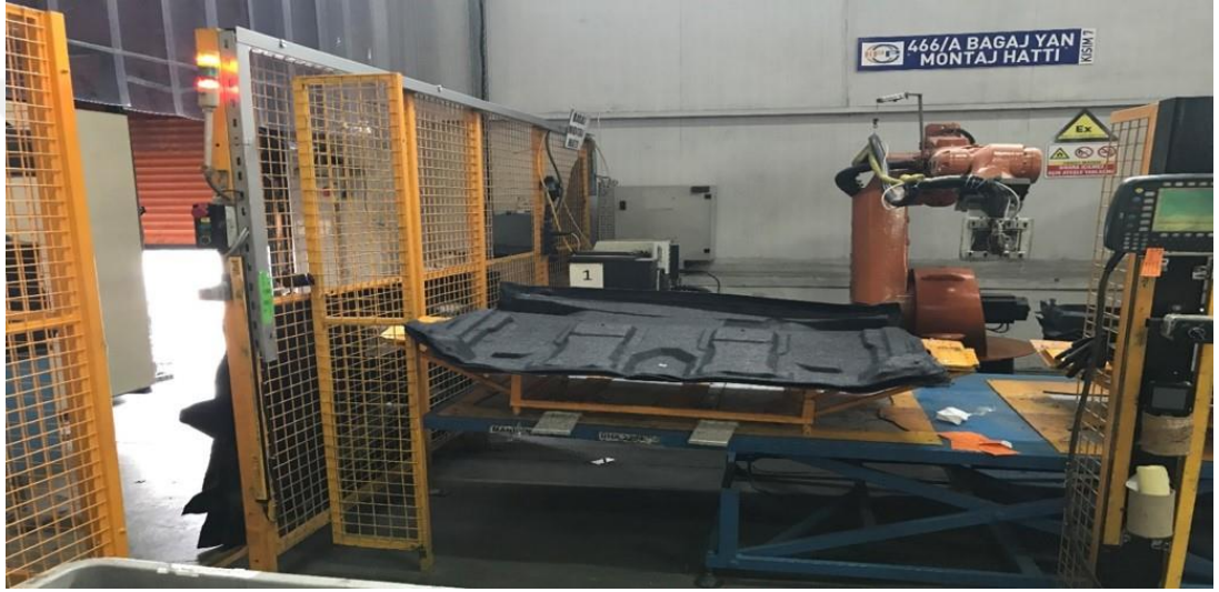
Şekil 5.10: Yapışkan Uygulama Rapotlu Sistemleri
