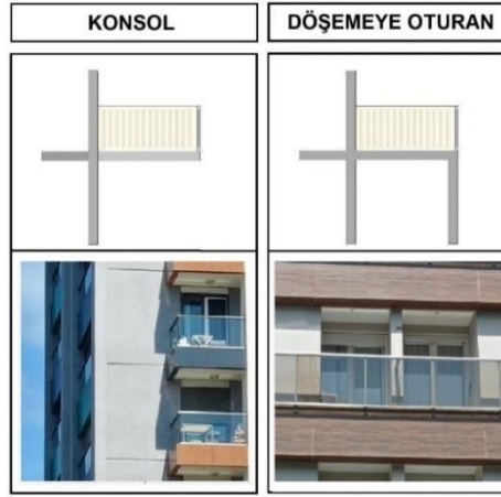
Şekil 2.87: Taşıyıcı Durumuna Göre Balkonlar
