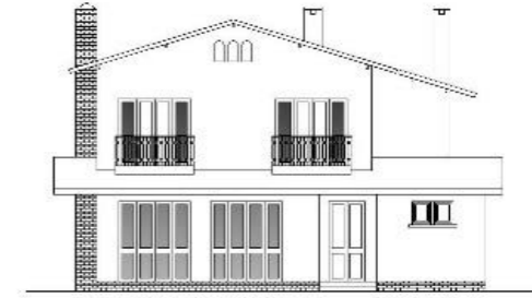
MÜSTAKİL YAPI GÜNEYBATI CEPHESİ H:6.50 m.
