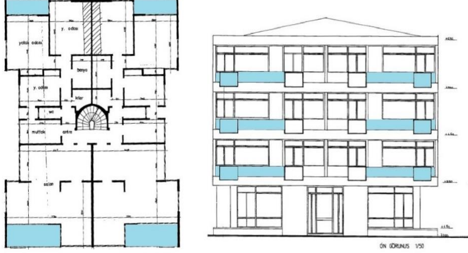
Şekil 3.56: Dilek Apartmanı 1. Normal Kat Planı ve Ön Görünüşü
