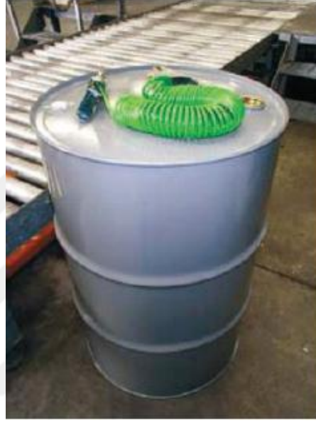
Şekil 5.12: Tipik Bir Solvent Kabı ve Topraklama Ekipmanı [17]
