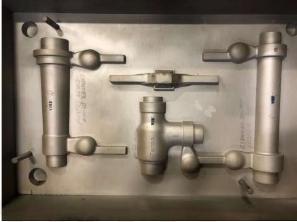
Şekil 5.2: Ejektör Tasarım-2 Ahşap Model
