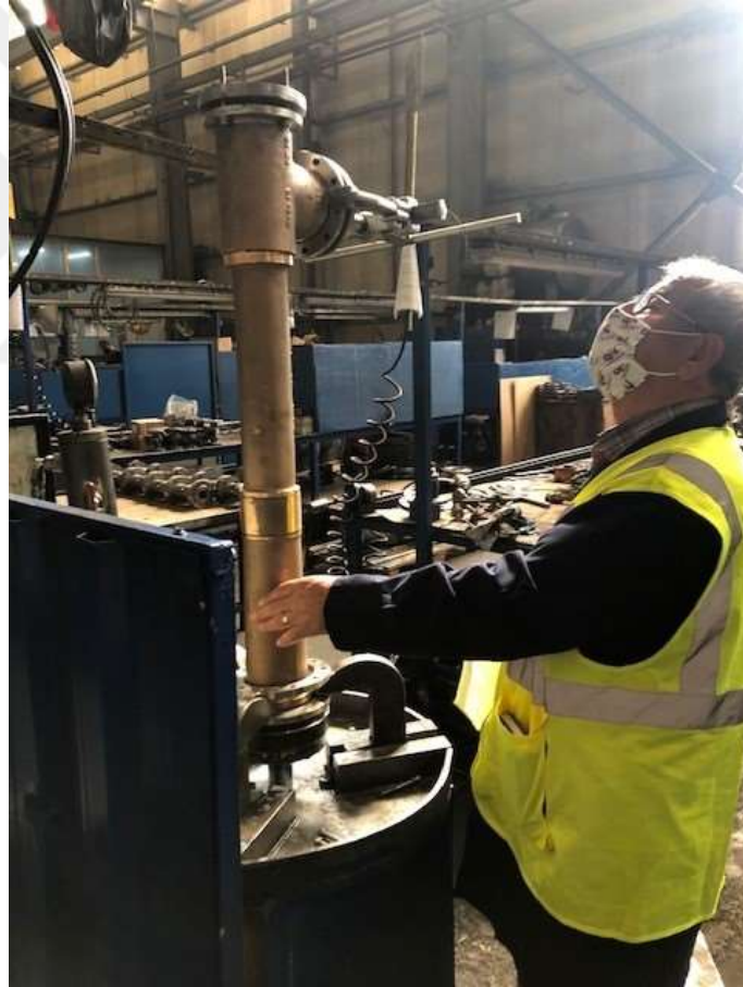
Şekil 5.8: Ejektör Sızdırmazlık Testi
