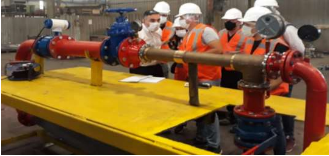
Şekil 5.11: Ejektör Kapasite Ölçümü Deney Düzenegi
